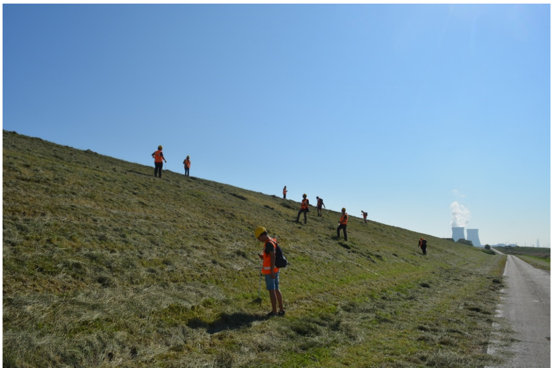
Figuur 3 Uitvoeren van de dijkspectie met prikstok (foto: A. Koelewijn, Deltares)
