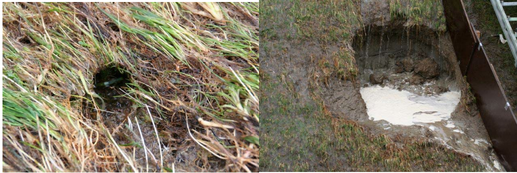
Figuur 6 Eindresultaat St Philipsland, na 50 l/s per m. Het mollengat was vanaf het begin van de proeven zichtbaar, maar heeft nooit tot verdere schade geleid. [Infram, 2008]
