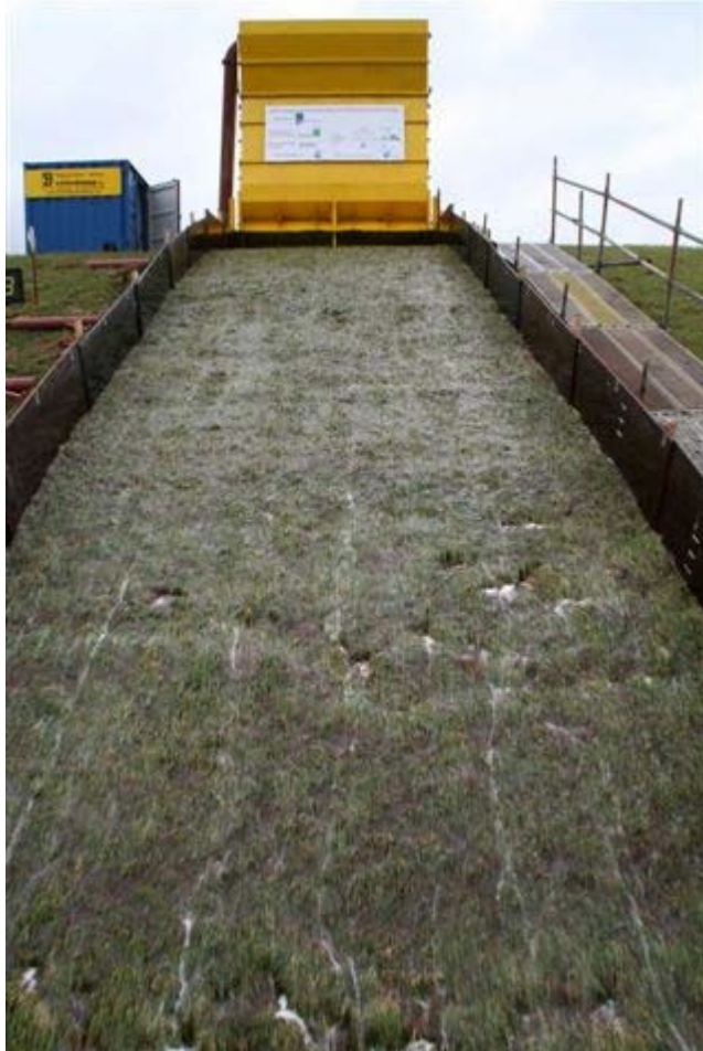
Figuur 5 Kattendijke, sectie 1, begin proef met 10 l/s per m. Matige bedekking met gras. In de hele sectie zaten ongeveer 80 molshopen en in het begin van de proef zijn de molshopen zelf weggespoeld, zodat de gaten/ingangen zichtbaar werden en soms ook de gangen als deze aan de oppervlakte lagen.
