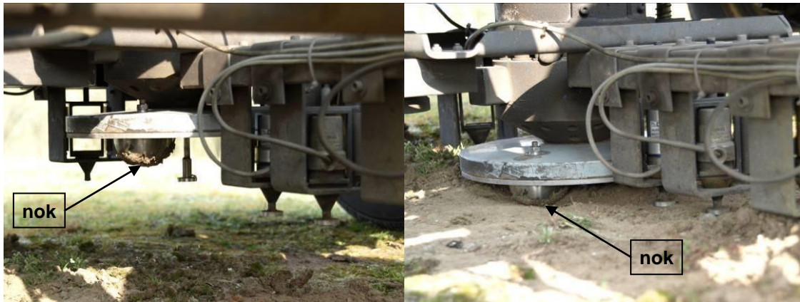
Figuur 2-2 Detailopname van de aangepaste deflectiesensoren en nokken onder de voetplaat
