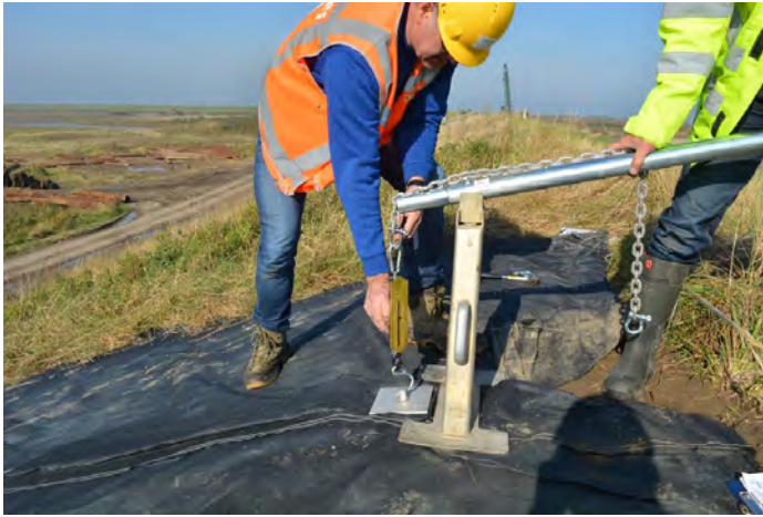
Figuur 50 De mechanische unster is aan de opening in de kop van de Wormi haring bevestigd.
