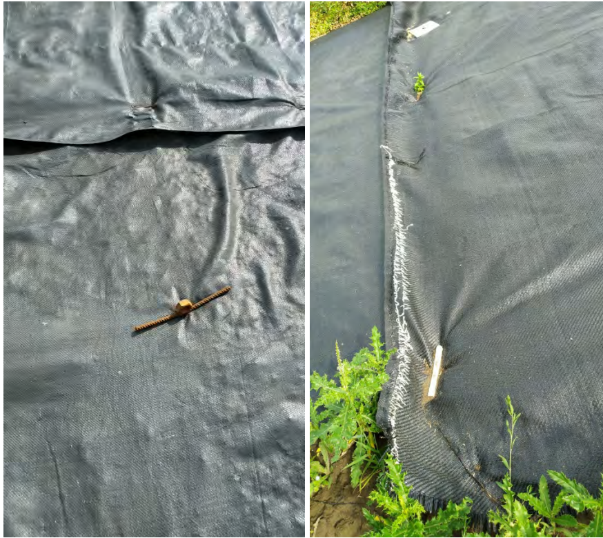
Figuur 28 De ijzeren Y-pen van ruw bouwstaal en de gladde kortere T-pen liggen nog steeds volledig tegen het doek aan.
