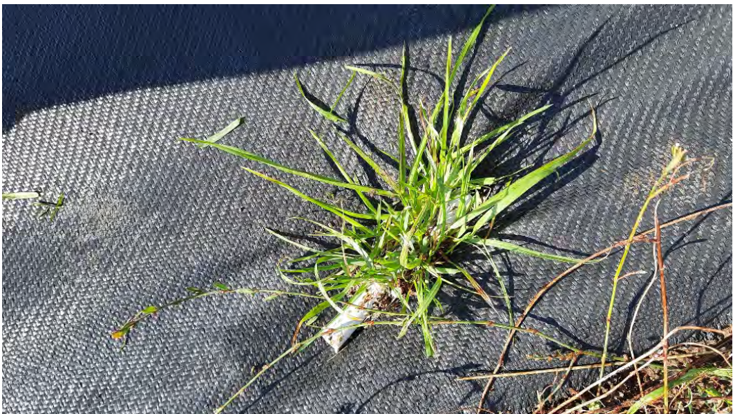
Figuur 46 Ook de kleinere T-krammen zitten vast in de grond en tegen het doek aan. De plek waar de kram de PE-folie heeft geperforeerd is de enige plek waar het gras groeit.
