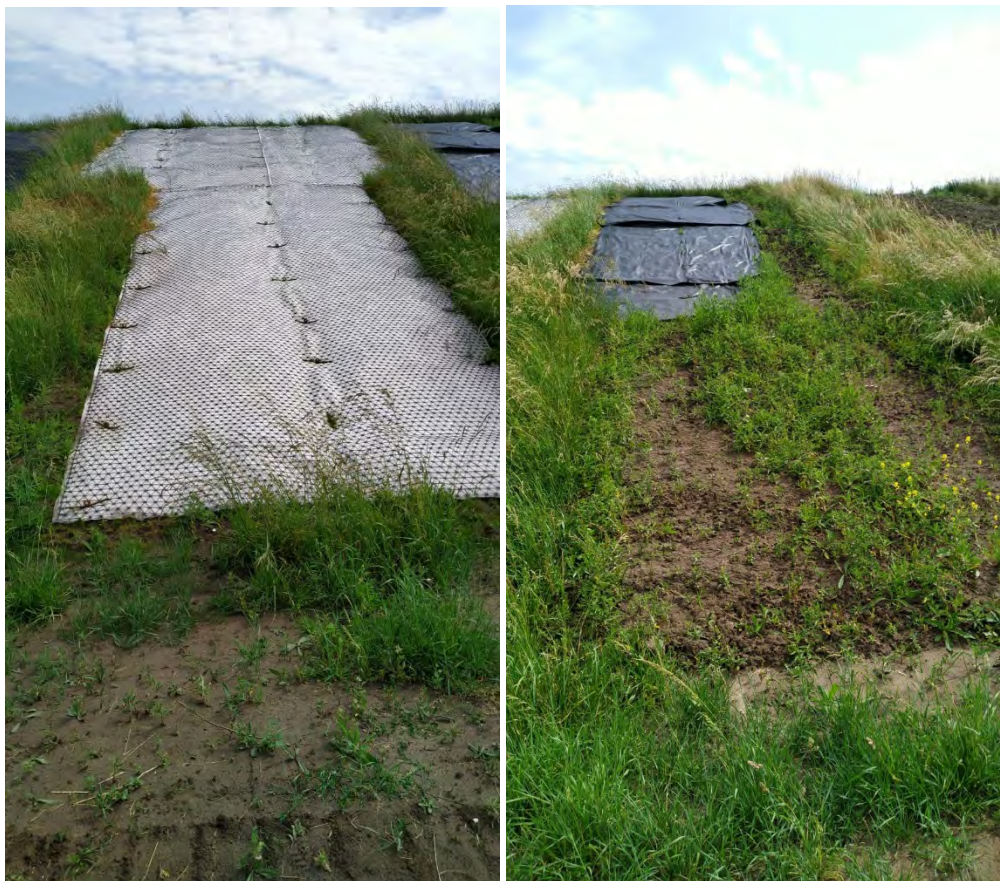
Figuur 27 Zicht op de strook met Tensarbekramming (links) en bekramming met dichtgewoven PE-doek (rechts). Bij beide stroken valt op dat onder deze doeken de groei van vegetatie nauwelijks gevorderd lijkt te zijn in tegenstelling tot de vegetatiegroei in de kleivlakken direct daaronder. De doeken liggen nog steeds vlak tegen het talud aan.
