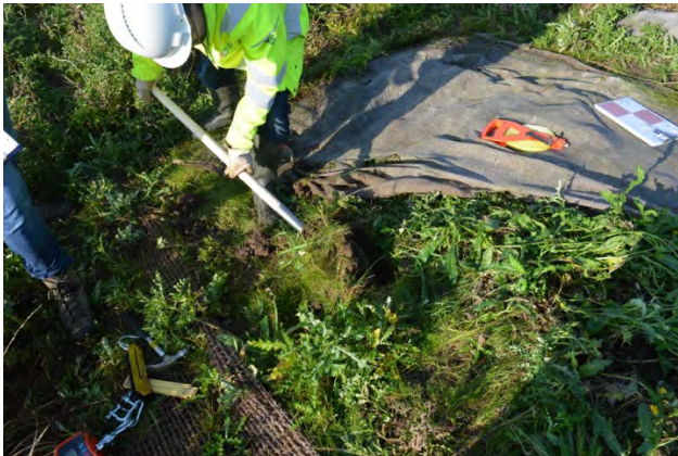
Figuur 36 Controle van de structuur van de ontstaande graszode door plagsteek methode (volgens Wettelijk Beoordelingsinstrumentarium (WBI)).
