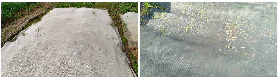
Figuur 25 De jutemat (links) wordt door de vegetatie omhooggeduwd. Hetzelfde geldt voor de sterk lichtdoorlatende PP-mat (rechts).
