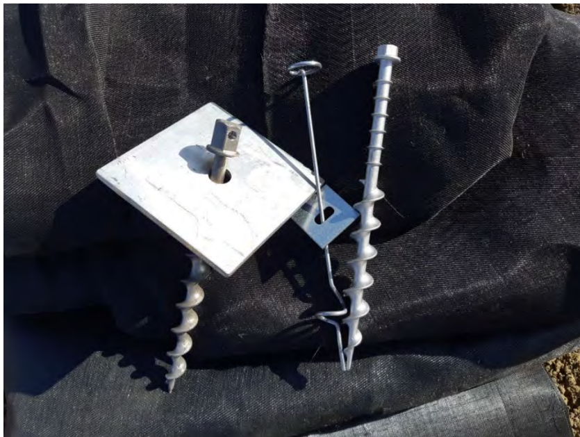
Figuur 7 links: Wurmi® (schroefvormige haring (30 cm lang) met contraplaat (150 x 150 mm, dikte 8 mm)). Midden: Gripple® TL-P3 (varkensstaartvormige Terra-Lock pin (30 cm lang) met TLP-washer (50 bij 50 mm)). Rechts: Peggy Peg (30 cm lang). De platen dienen voor een betere fixering van het doek en een betere krachtoverdracht door gewichtsspreiding. Beide pinnen worden middels een boor-adapter en een accuschroevendraaier in de grond geboord. De schroefharingen en contraplatten zijn van aluminium.
