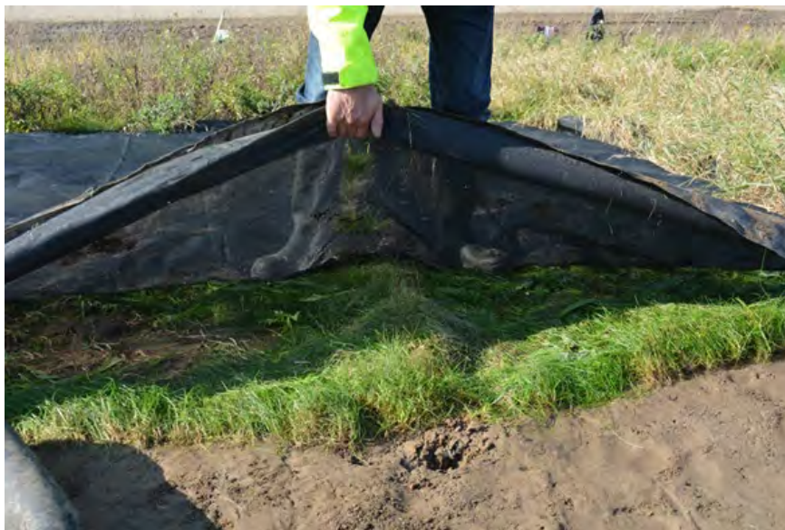
Figuur 39 Zicht onder het zeer doorschijnende PP-doek op de goed ontwikkelde graszode.
