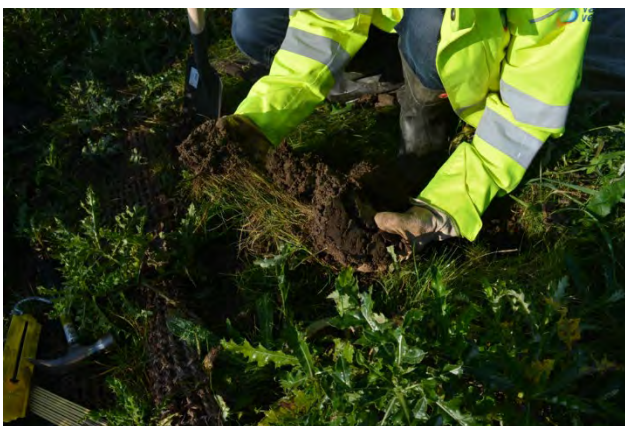
Figuur 36 Controle van de structuur van de ontstaande graszode door plagsteek methode (volgens Wettelijk Beoordelingsinstrumentarium (WBI)).
