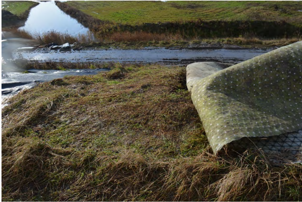
Figuur 70 Blik op de graszode onder het onderste gedeelte van de bekramming. Dit bekrammingsgedeelte vormt de smalle strook die alleen op klei kwam te liggen. Hier heeft zich een dichte graszode ontwikkeld, die weinig erosieschade toont.
