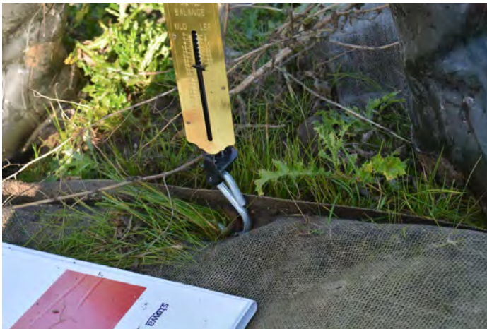
Figuur 51 De haak van de unster zit onder de zijpinnen van de biologisch afbreekbare polymeerpen.
