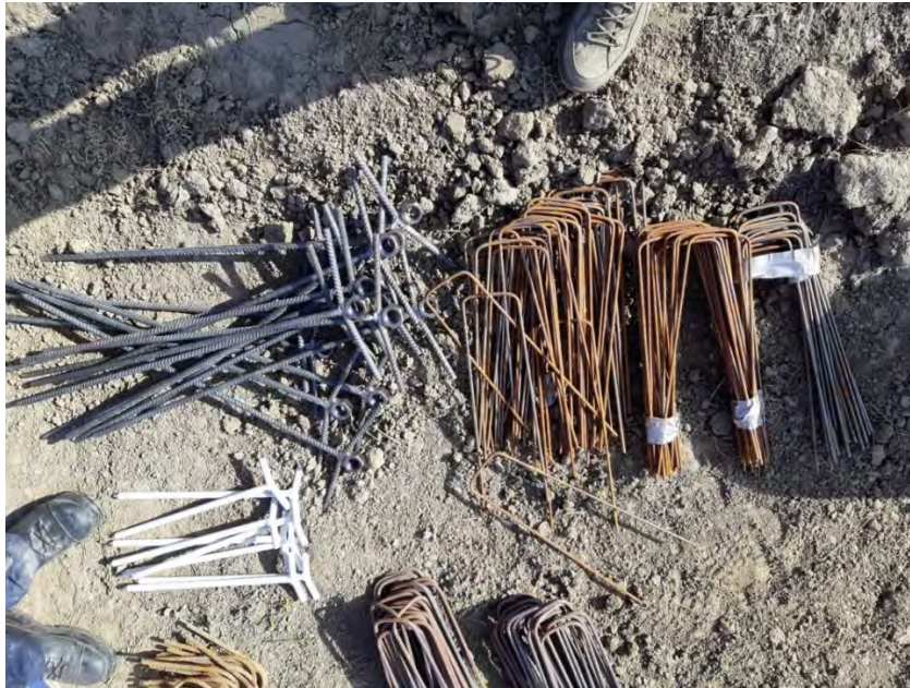
Figuur 6 Verschillende types krammen om doek op de grond te fixeren: Y-pinnen met oog (van bouwstaal met ruw oppervlak, 45 cm), U-krammen (30 cm), T-pinnen (wit met glad oppervlak, 40 cm).
