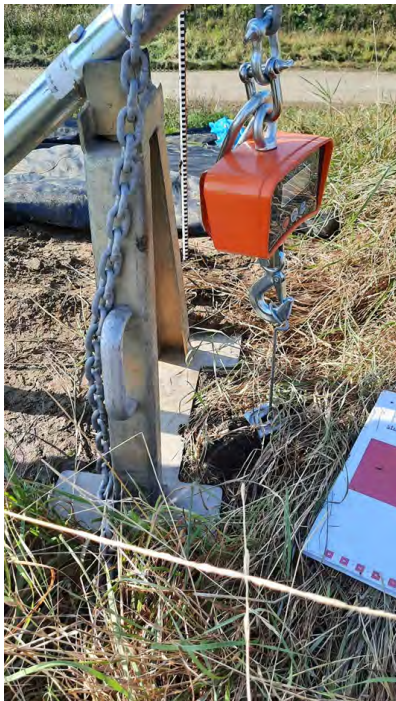
Figuur 52 Tijdens het trekken van de Terra-Lock pin overschrijdt de pen de rekgrens van het materiaal en vervormt.
