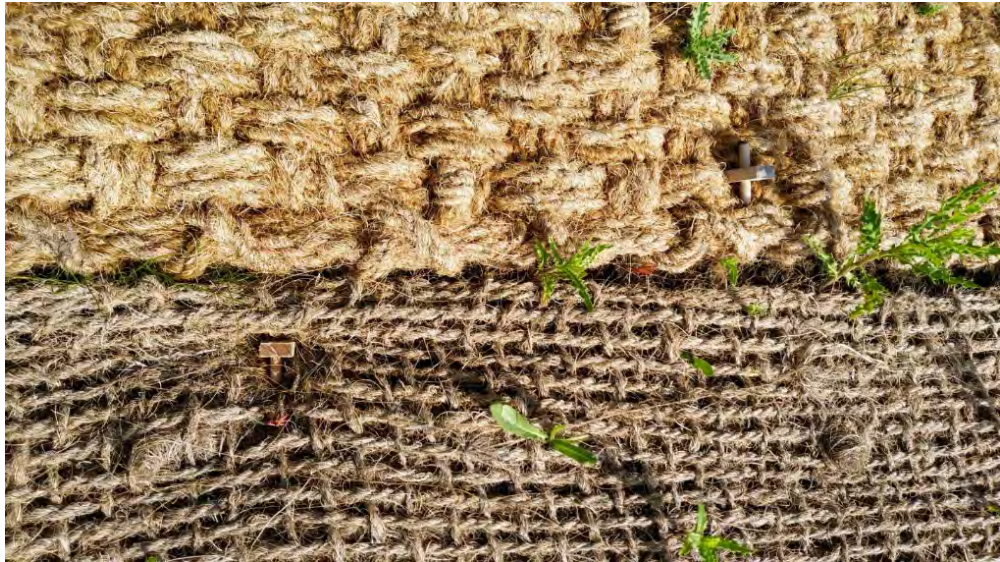
Figuur 26 Bovenaanzicht van de bio-afbrekbare pennen in de kokosmat (boven) en het jute doek (beneden). De pennen zitten vast op de doeken. Bij de pen in het jute doek is een zijpin afgebroken tijdens het inslaan van de pen. De kokosmat heeft een zeer dichte gewoven structuur waar de planten minder sterk doorheen groeien dan door de open weefselstructuur van het jutedoek.
