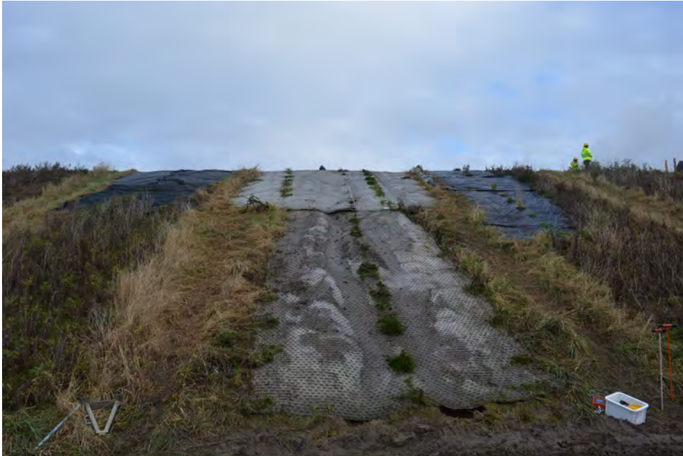
Figuur 62 De erosiegleuven tekenen zich duidelijk af onder de bekramming.
