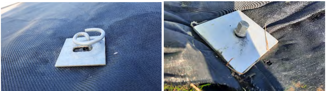
Figuur 47 De Terra-Lock pen en de Wurmi zitten niet meer vast tegen de contraplaat aan.
