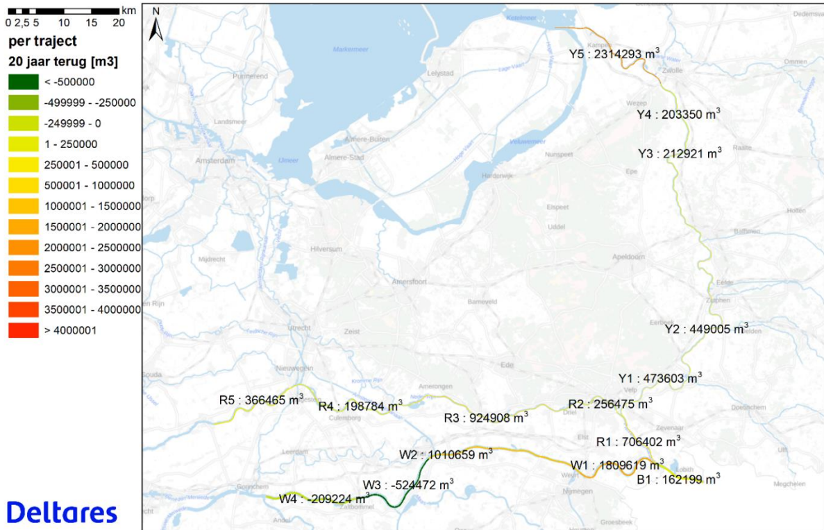
Figur 3-3 Benodigd volume per traject voor het herstellen van de bodem van 1999.
