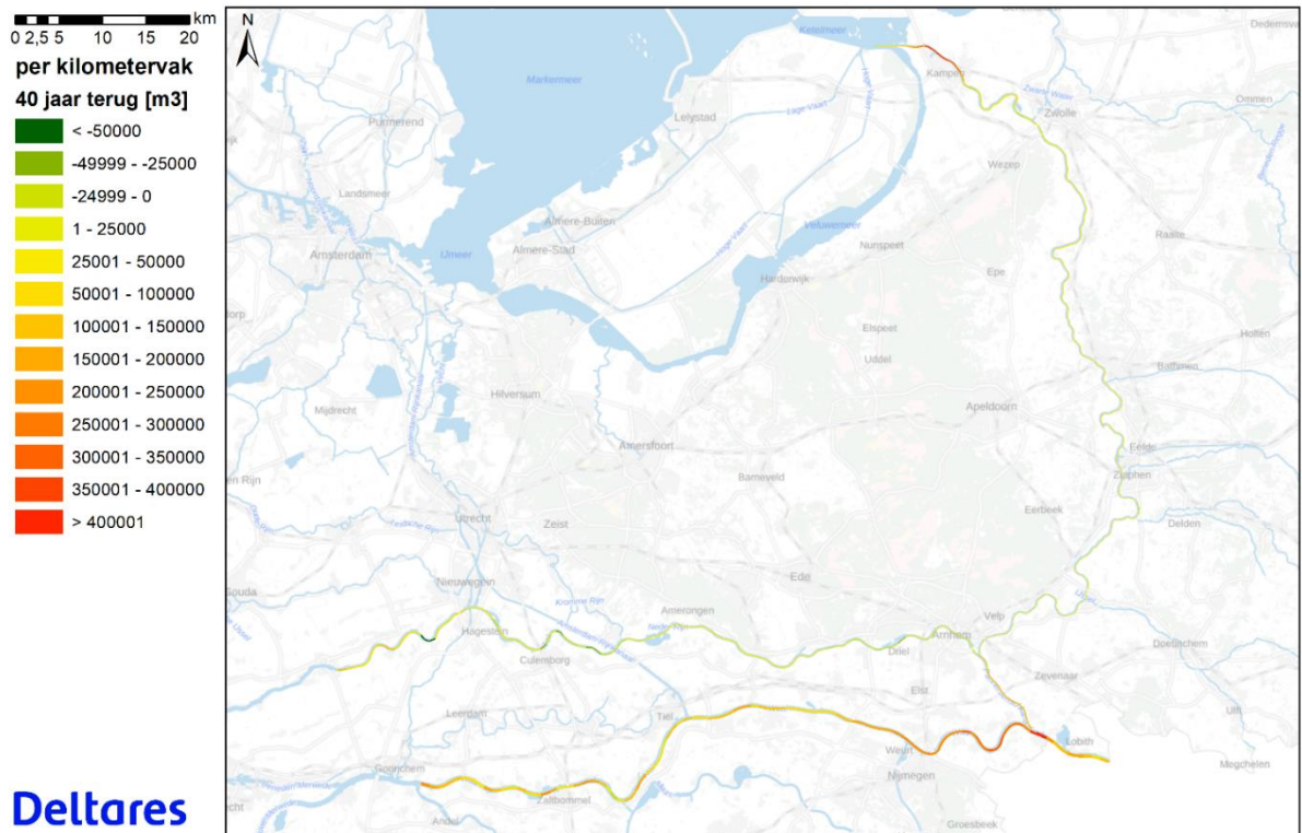
Figuur 3-7 Benodigd volume per rivierkilometer voor het herstellen van de bodem van 1980.
