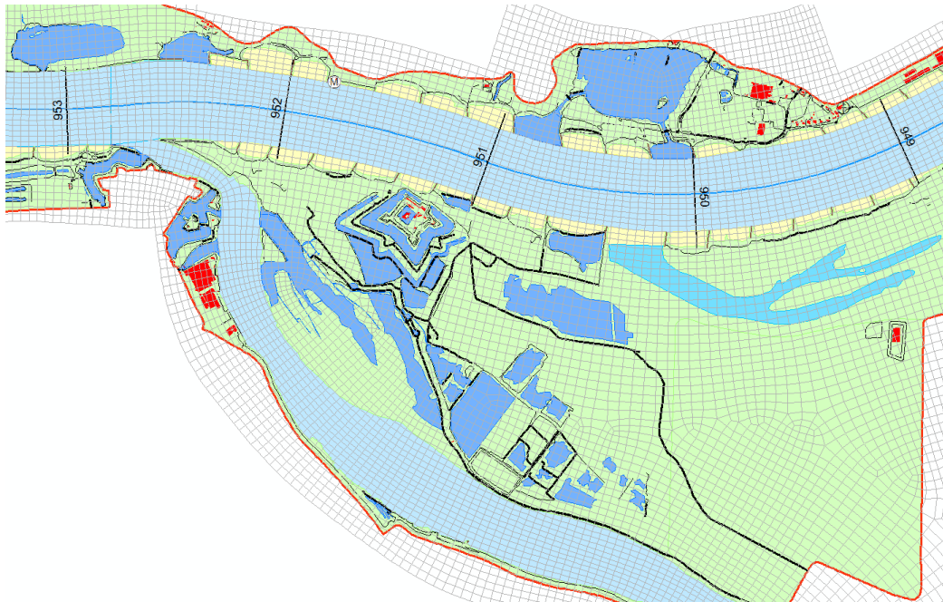
Figuur B.5 Het rooster volgt zowel de Afgedamde Maas als het zomerbed van de Waal en Boven-Merwede.
