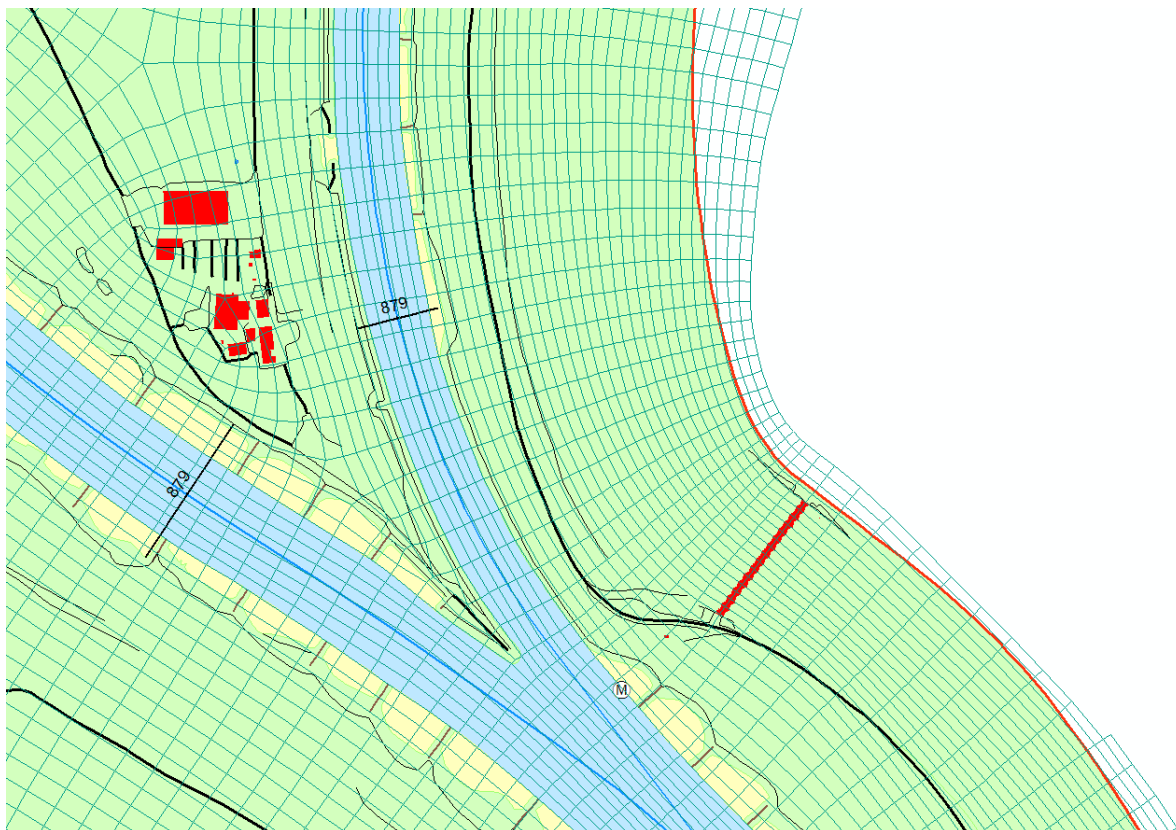
Figuur B.2 Het rooster op de IJsselkop en Hondsbroeksche Pleij. De achterliggende baseline-schematisatie is j16_5-w4.
