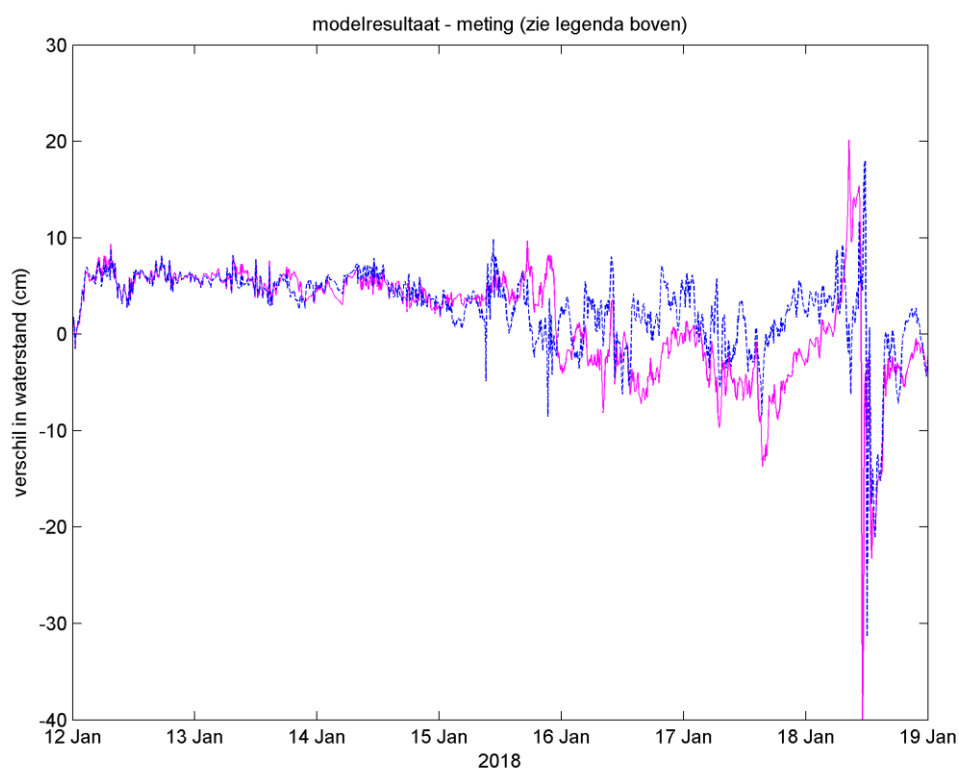
Figuur I-11 Vergelijking van gemeten en met D-Flow FM met verschillende windforceringen berekende waterstand voor de stormperiode in januari 2018 bij observatiestation Ramspolbrug. Boven de waterstand in [cm] t.o.v. NAP, beneden het verschil van berekende waterstand minus gemeten waterstand in [cm].
