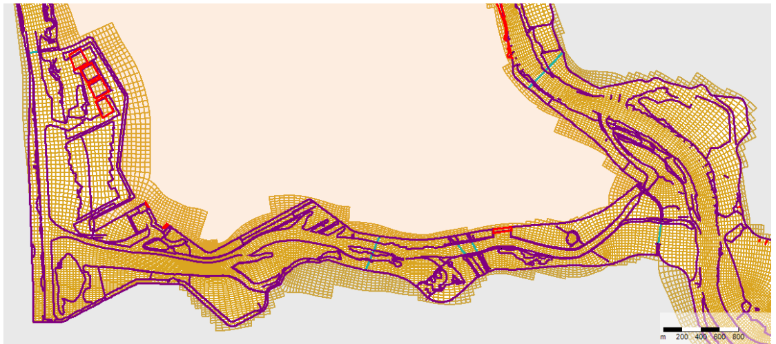
Figuur 3-3 Geactualiseerd Reevediep. Rekenrooster, vaste overlaten (paars), dunne dammen (rood), permanent droog (zalmroze) gebied tussen de IJssel en het Revemeer en brugpijlers (blauw-groen). Het grijze gebied is buiten de modelbegrenzing. De inlaat Reevediep ligt onder de meest rechtse brug.
