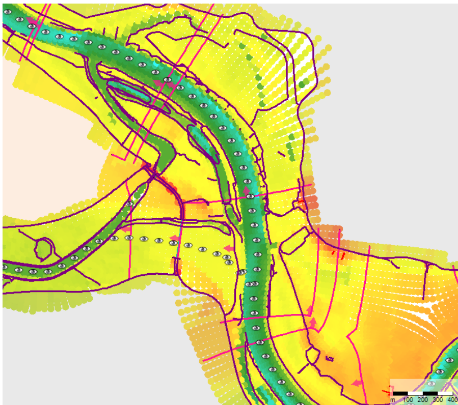
Figuur 3-5 Bodemhoogte (m+NAP) rond de inlaat van het Reevediep (kleurschaal in Figuur 3-4). Ogen zijn locaties voor observatie van de waterstanden, de roze lijnen met pijlen de dwarsdoorsnedes voor observeren debiet.
