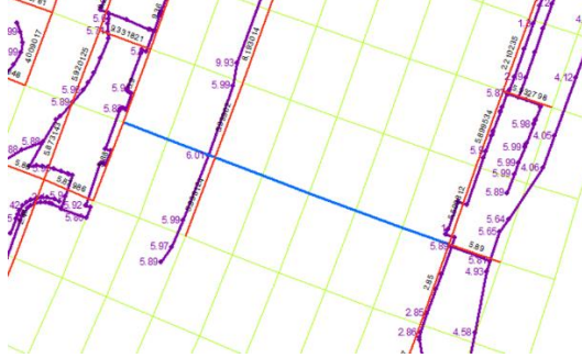
Hollandsche IJsselkering: Overlaatlĳnen en overlaathoogtepunten na conversie naar D-HYDRO (paars) en zoals deze naar het rooster zĳn omgezet (Snapped: rode lĳnen + zwarte hoogtes).
