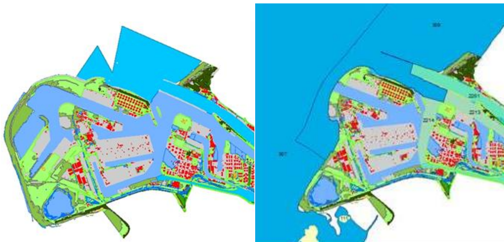
Figuur 1 Land_use_polygons bij de Tweede Maasvlakte in RMM-j19_5-6g-w2 (links = goed) en in Baseline-NL j19_6-v1 (rechts = fout)
