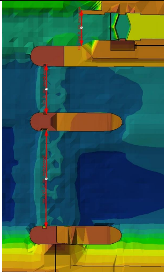
Bodemhoogte en overlaten Hartelkering.
