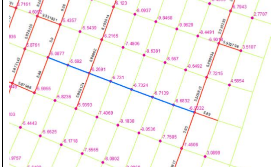
Hollandsche IJssel: Overlaten Snapped: rode lĳnen + zwarte hoogtes, kunstwerklĳn (blauw) en bodemhoogtepunten(roze).
