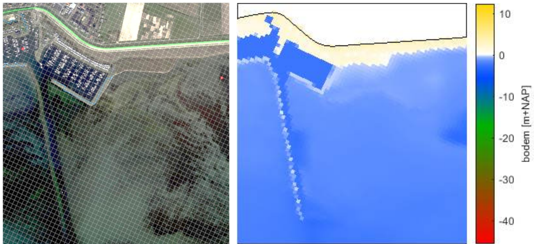
Figuur 3.3: Detailoverzicht van het rekenrooster bij de haven van Herkingen. In het linker paneel is een satelliefoto weergegeven waar de groene lijn de modelrand uit Baseline betreft, de rode markers de voorlopige uitvoerlocaties en de blauwe lijn de obstakels weergeeft. Het rechterpaneel geeft de bodem weer.
