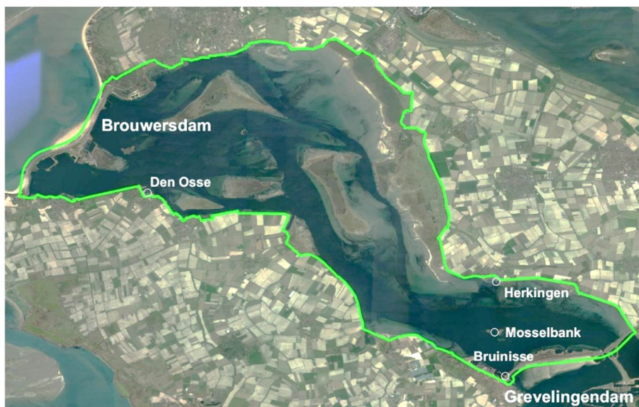
Figuur 3.1: Domein Grevelingen SWAN-schematisatie. De groene lijn geeft de modelbound uit Baseline weer.
