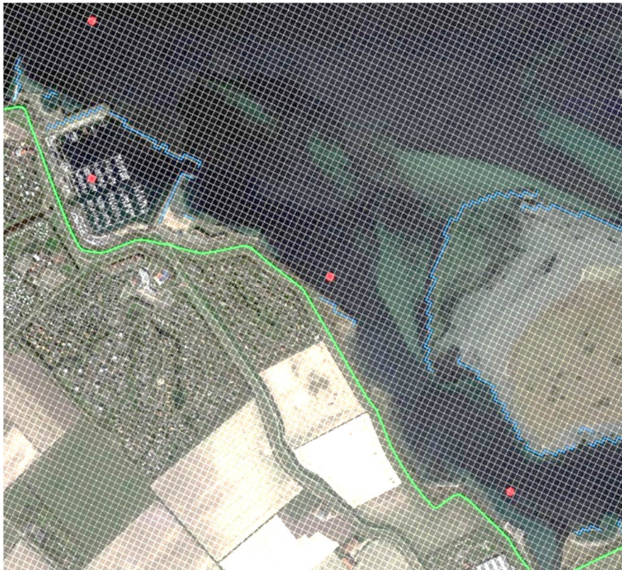
Figuur 3.2: Detailoverzicht van het rekenrooster bij de haven van Den Osse. De groene lijn betreft de modelrand uit Baseline, de rode markers de voorlopige uitvoerlocaties en de blauwe lijn geeft de obstakels weer.
