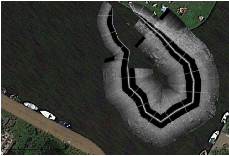
Figuur 3.9. Beelden van de zij-scan van het sonarbeeld bij Admiralengracht geplote over satelliet data. De verschillende afbeeldingen komen overeen met verschillende passages met het onbemande oppervlaktevoertuig.
