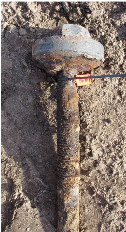
Figuur A.11 Uiteinde van een anker met moer en 'ring'
