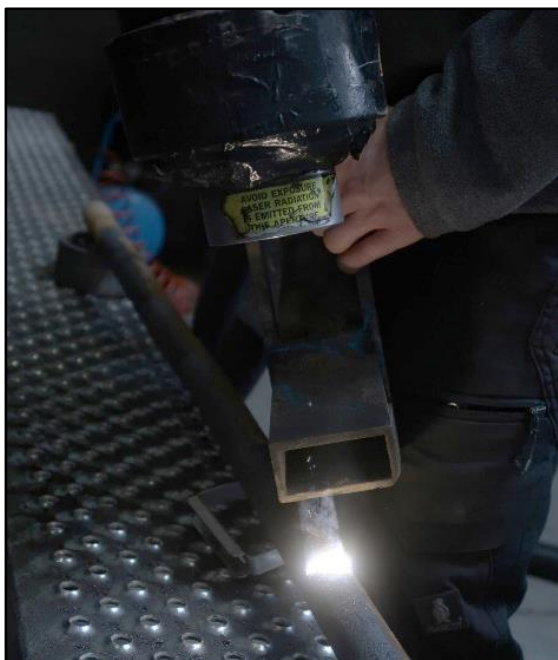
Figuur 2.15 Laserreinigen van een ankerstuk.
