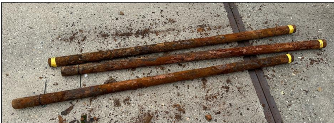
Figuur 2.14 Hanteerbare stukken ankerstang met tijdelijke markeringen.
