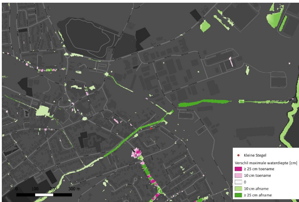
Figuur 20 Verschilkaart met effect van bronmaatregelen voor T=100 (bronmaatregelen versus geplande maatregelen Rimburgerweg). Ter hoogte van de Veldhofstraat (in het zuiden) zijn enkele vlekken met een toename te zien; dit is waarschijnlijk het gevolg van interpolatie-artefacten van de berekende waterdieptes. Het is advies is om dit nader te onderzoeken en zo nodig het model hier op aan te passen
