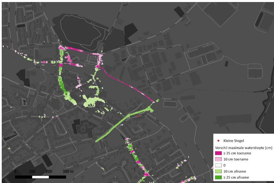
Figuur 19 Effect geplande aanpassingen Rimburcherweg bij T=100 (verschil met huidige situatie). Ter hoogte van de Veldhofstraat (in het zuiden) zijn enkele vlekken met afwisselend een toe- en afname te zien; dit is waarschijnlijk het gevolg van interpolatie-artefacten van de berekende waterdieptes. Het advies is om dit nader te onderzoeken en zo nodig het model hier op aan te passen
