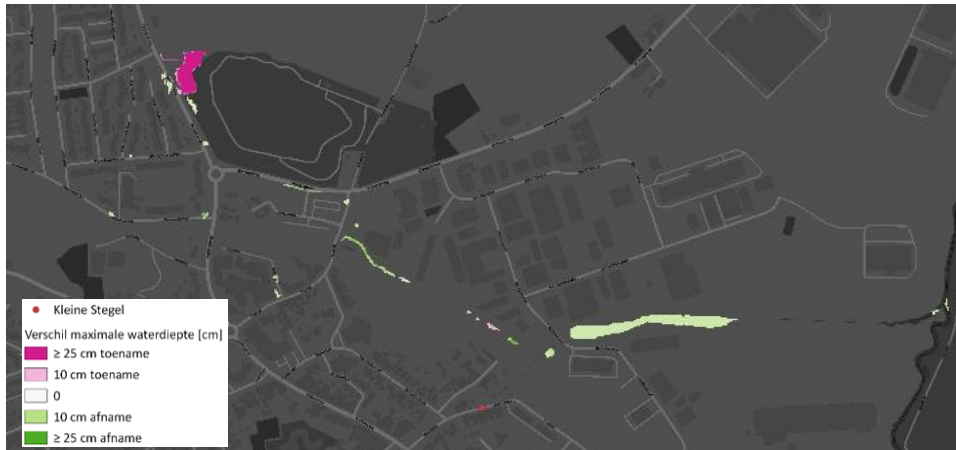
Figuur 21 Verschilkaart met effect van laagte naast Hermansgroeve als regenwaterbuffer voor T=100
