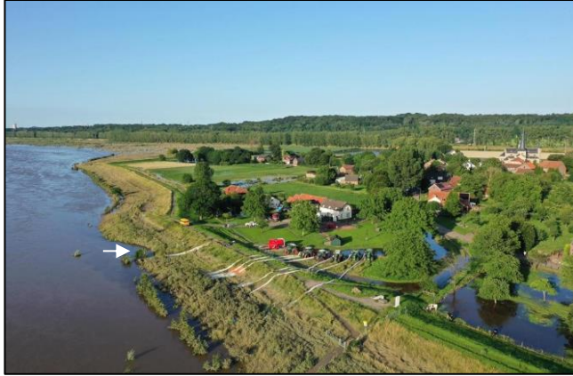
Figuur 3.12 Afwatering bij Geulle aan de Maas naar de Maas met 6 tractorpompen en 1 pomp van de brandweer (bron: persoonlijke communicatie Waterschap Limburg). De ligging van de Oude Broekgraaf (vrije afwatering) is aangegeven met een witte pijl
