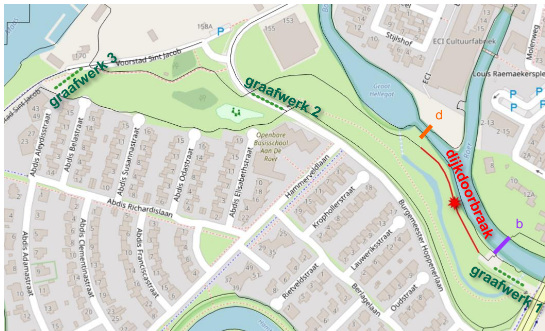
Figuur 2-3: Locatie van de gesimuleerde dijkdoorbraak (rode lijn) en locaties waar graafwerk uitgevoerd moet worden (groene stippellijnen) bij inzet van de Roer-overlaat. Verder illustreert b de zuidelijke keersluis en d de stuw Groot Hellegat
