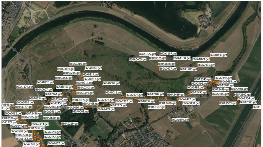
Figuur 5.1 Boringen voorland dijkvak GK29.
