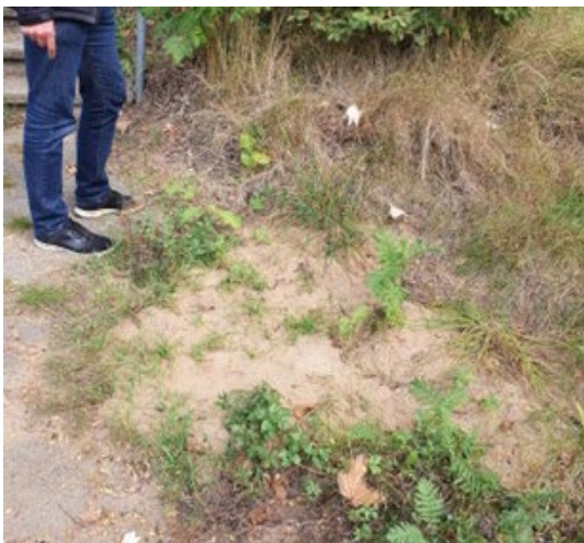
Figuur 3.19 Zandmeevoerende wellen bij locatie (2) tijdens het veldbezoek na hoogwater.
