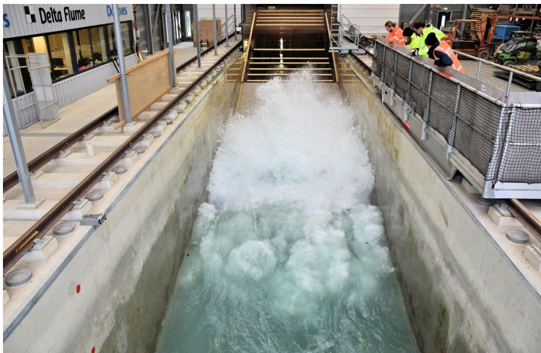
Fig. C-1 Golfaanval op testsectie van Quattroblocks
