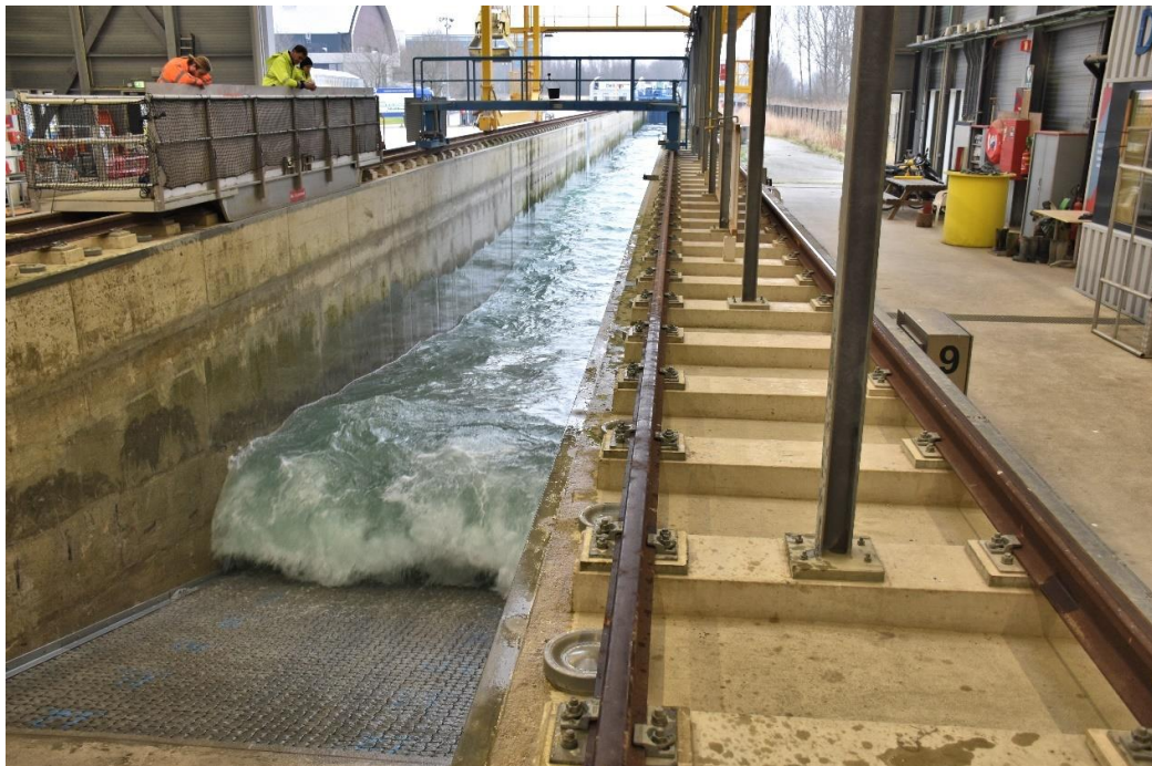
Golfbelasting in Deltagoot op talud met Quattroblocks
