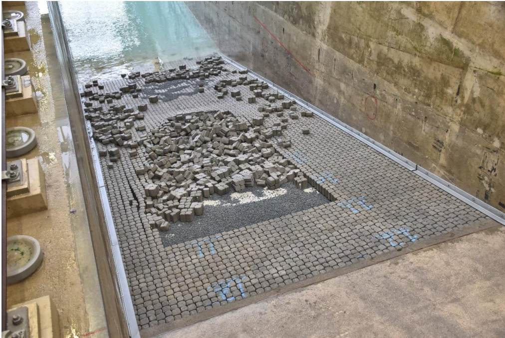
Figuur 4.5 Aan het eind van QB-10 (langeduurproef) zijn zetstenen uit de bekleding gespoeld
