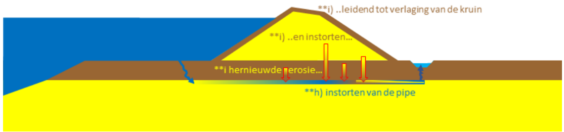
Figuur 2.19 Buitendijkse graverij, faalpad met falen door herhaald instorten van de pipe, tot aan kruinverlaging
