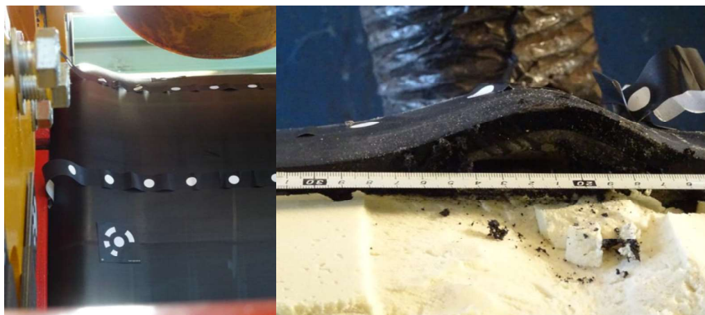
Figuur 4.32 Bezwijkvorm leiding, de witte stippen op de leiding zijn gebruikt voor de fotogrammetrie (foto: Deltares).
