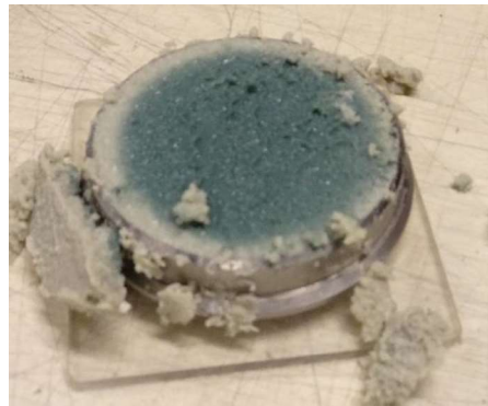
Figuur 1: Preparatie Drill-Grout monster.
