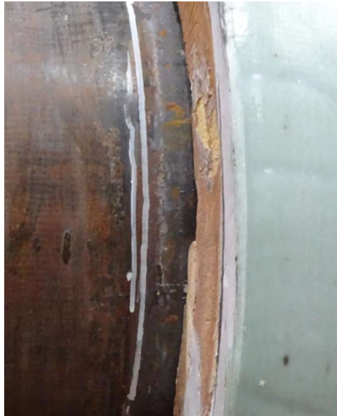
Figuur 4.23 Verschuiving PUR t.o.v. staal aan einde test, witte lijn is oorspronkelijke positie einde PUR t.o.v. staal, test na omdraaien leiding (foto: Deltares).
