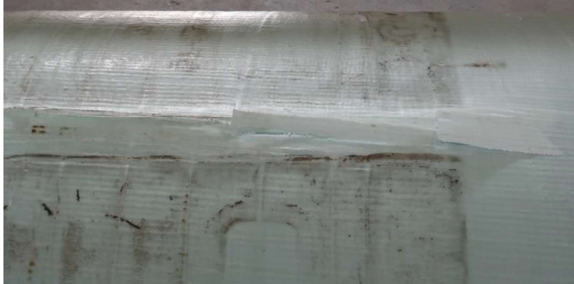
Figuur 3.1 Bezwijkmechanisme GRP leiding bij alleen klemkracht (foto: Deltares).
