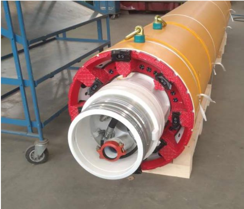
Figuur 2.7 EPP met ruimer (foto: Herrenknecht).
