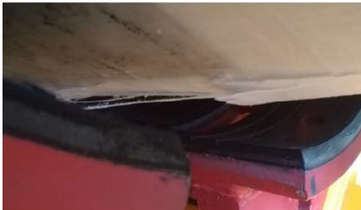
Figuur 3.2 Bezwijkmechanisme GRP leiding bij alleen een klemkracht (foto: Herrenknecht).
