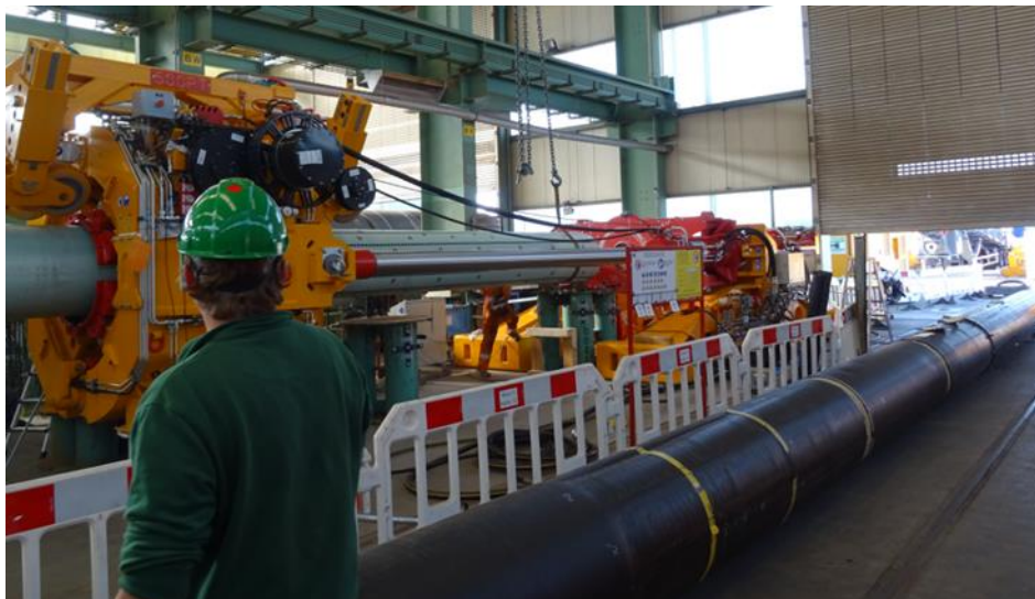
Figuur 6-1 Meetopstelling, links de klem van de thruster en rechts het reactieframe; op de voorgrond ligt de gebruikte buis zonder GRP laag, in de opstelling de gebruikte buis met GRP laag (foto: Deltares).
