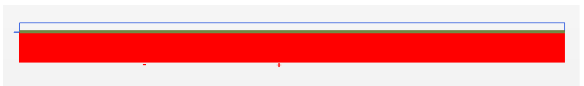
Figuur B.2 Gemobiliseerde wrijving in de interface, deze moet over de volle lengte gelijk zijn aan de voorgeschreven schuifsterkte om sprake te laten zijn van een situatie bij installeren van de leiding.
