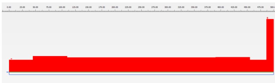
Figuur 5.18 Wrijving in de interface leiding-grond.
