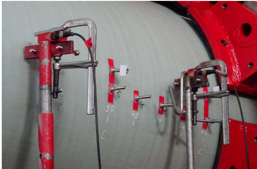
Figuur 4.27 Plaats 5 meetboutjes en 2 reflectoren op leiding, meting 4 november (foto: Deltares).
