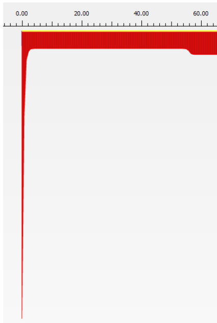
Figuur 4.6 Verloop afschuifkracht in de isolatielaag, detail bij intrekking, lengte HDD (horizontaal) is 1000 m.
