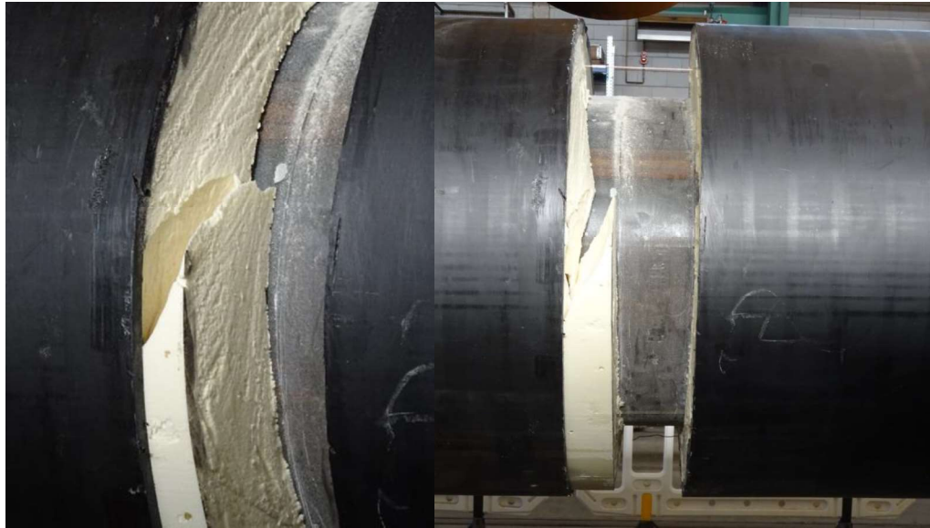
Figuur 4.33 Axiaal bezwijken (foto: Deltares).
