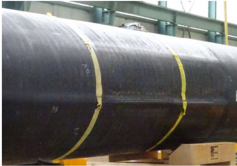
Figuur 3.3 Bezwijkvorm PE leiding bij alleen klemkracht (foto: Deltares).
