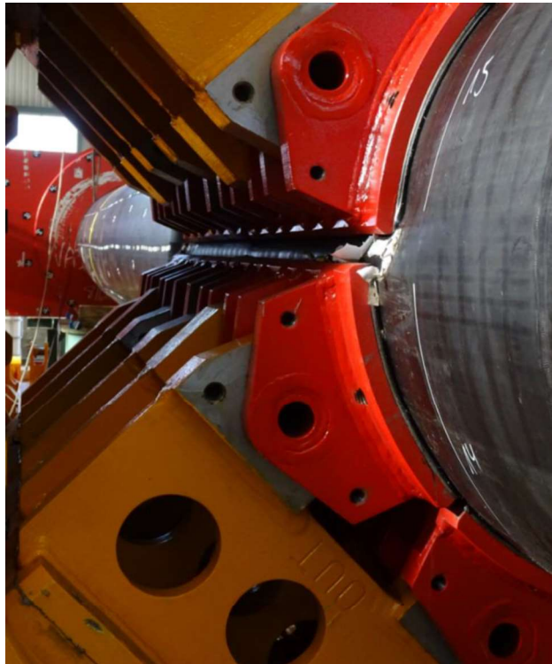
Figuur 3.4 Detail klem en leiding (foto: Deltares).
