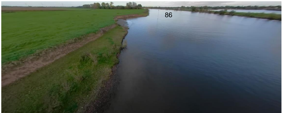
Figuur 4.16 Screenshot in benedenstroomse richting van de erosiekom in sectie 2 van oever 1A. Ook zichtbaar is het bakken van rkm 86, het brede geleidelijke en begroeide oeverstrand met grindlaag aan de waterlijn in sectie 1 en het kale oeverstrand zonder grind aan de voet van de steilrand in de erosiekom van sectie 2.
