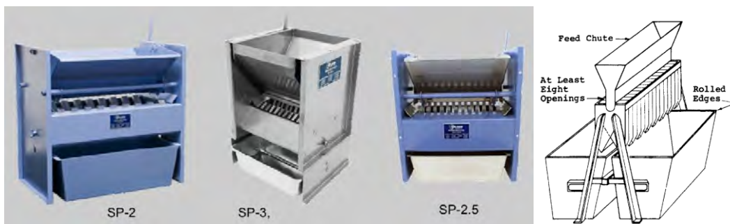
Figuur 3-10 Splitsen van monsters: het mengsel wordt aan de bovenzijde ingestort, waarna het via de verdeler (middendeel) wordt gesplitst in twee delen in de twee bakken aan de onderzijde.
