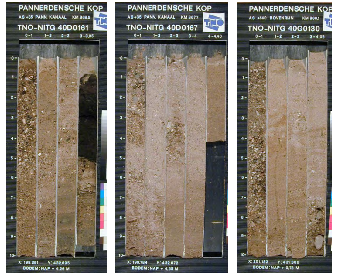
Figuur 3-25 Boringen van de rivierbedding in Pannerdensch Kanaal (links en midden) en Boven-Rijn (rechts) met grofkorrelige actieve laag op een minder grof substratum (afstand op verticale as in centimeters) (Grujters et al, 2001a). Actieve laag in Pannerdensch Kanaal is gesteld op orde 50 cm, en in Boven-Rijn orde 1 m.
