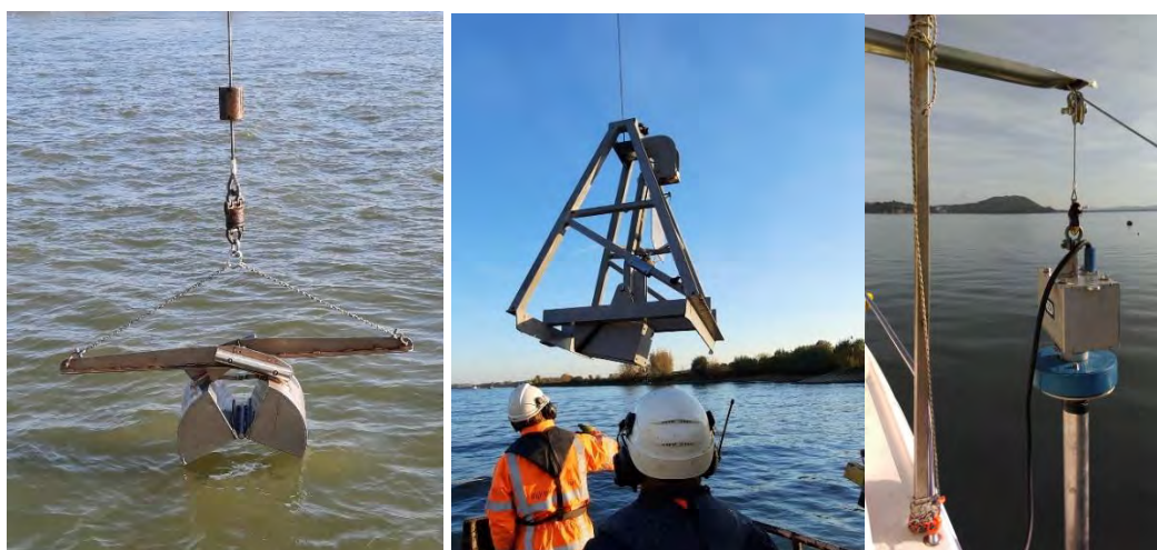
Figuur 3-1 Links de Van Veen happer, midden de Hamon happer, rechts de Vibrocore
