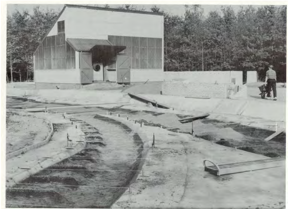
Figuur 1-1 Schaalmodel Pannerdensche Kop bij het Waterloorkundig Laboratorium in de Voorst in 1981: op achtergrond staat de loods met zeefinstallatie voor het sediment-recirculatiesysteem (Sloff et al., 2003)
