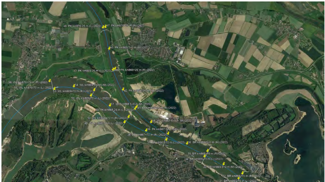
Figuur 2-20 Locaties van monsters voor suppletieproeven, gebruikt voor de tijdmiddeling van splitsingspuntsamenstelling. De monsters in de as zijn telkens versprongen ten opzichte van de monsters op de linker en rechterzijde van de as. De afstand in langsrichting bedraagt telkens 1 km, en de locaties zijn gelijk voor alle monster tussen 2016 en 2022.
