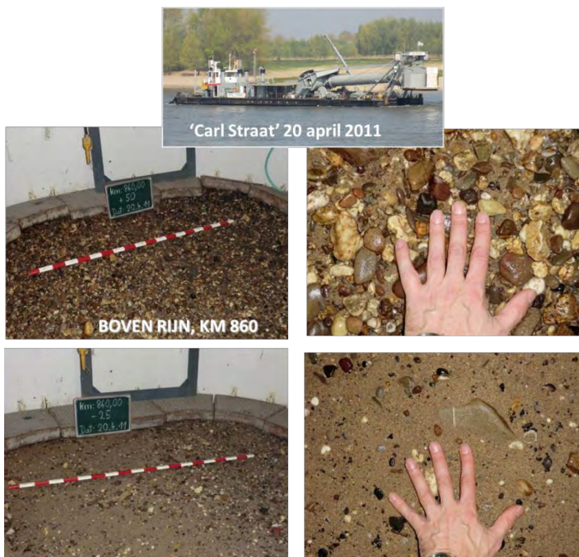
Figuur 3-17 Variabiliteit in bodemsamenstelling in raai km 860 (Boven-Rijn) op 20 april 2011. Foto boven: op 50 m rechts van as; Foto onder: op 25 m links van as (waarnemingen met duikerklok)
