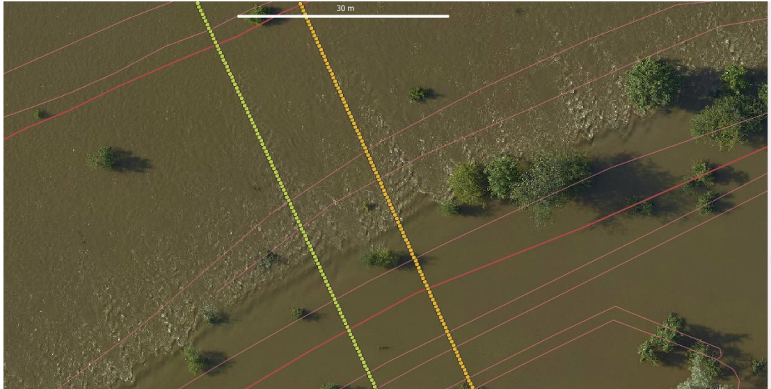
Figuur 3-11 Detail van luchtfoto bij Roermond Ooldersplas met daarop zichtbaar dat het obstakel als overlaat fungeert. Data is ingewonnen op 17/07/2021 17:01.
