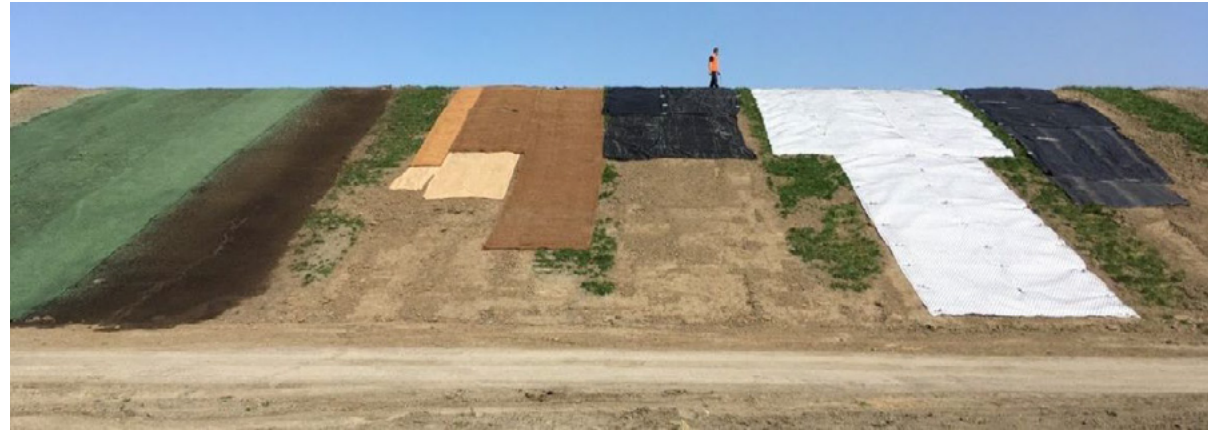
Diverse typen bevestigingen op een dijkwalud
