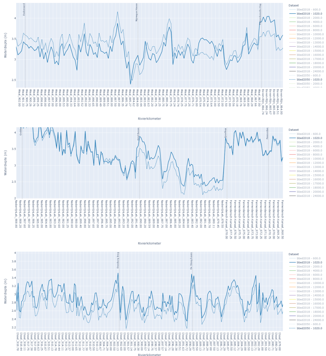
Figuur 7.1 Langsdoorsnede van de waterdiepte bij een afvoer van 1.020 m 3 /s bij Lobith bij de huidige 2018 bodem (doorgetrokken lijn) en de bodem 2050 (stippellijn). Boven: Boven-Rijn en Boven-Waal; midden: Pannerdensch Kanaal en Nederrijn; onder: Boven-IJssel.
