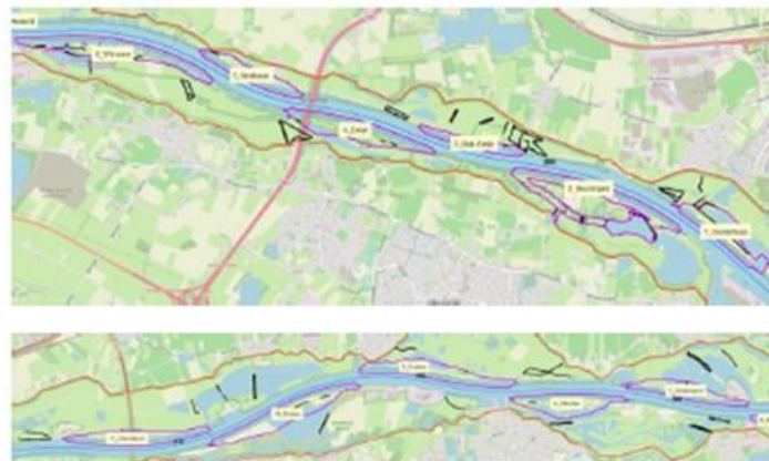
Figuur 24 Contouren van de maatregelen. De rode lijn is de bandijk en begrenzing van de rekenmodellen. De paarse contouren representeren de zomerbedversmalling en geulen. De zwarte lijnen en contouren representeren maaiveldverlagingen en verwijdering of verlaging van kades.
