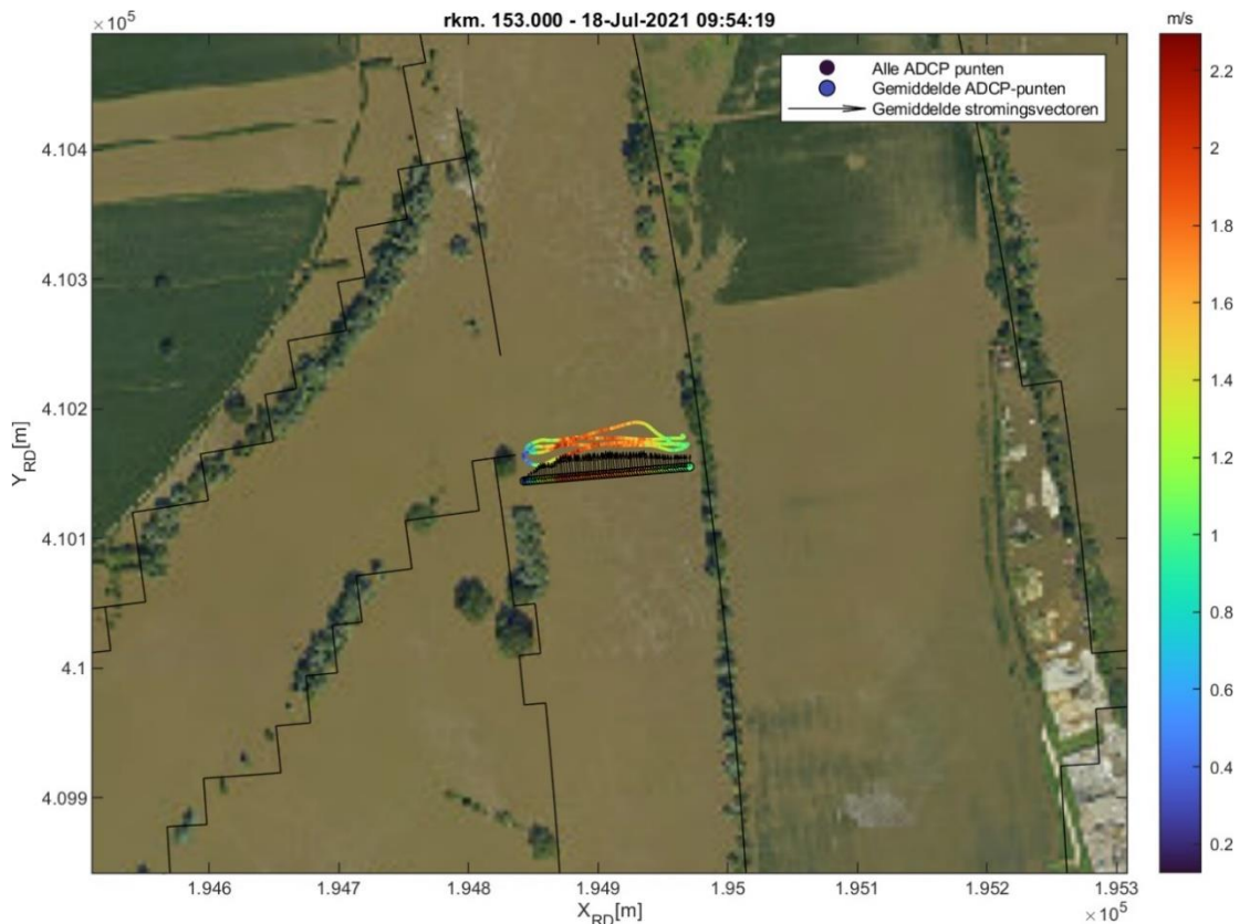
Figuur 2.4 Projectie van de ADCP-metingen van 18 juli 2021 naar diepte gemiddelde stroomsnelheidsvectoren langs de gefitte rivierkilometerraai van rivierkilometer 153
