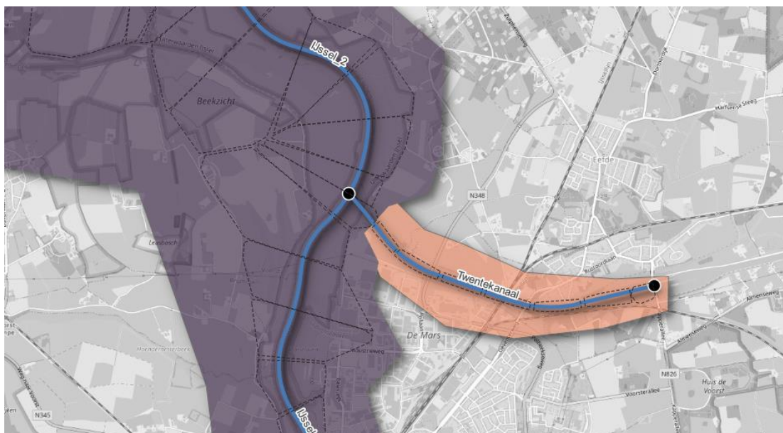
Figuur 2-5 Het Twentekanaal heeft een apart gebied om te voorkomen dat profielen op het Twentekanaal 2D resultaten gebruiken die moeten worden toegewezen aan de IJssel. Echter, omdat SOBEK altijd een rekenpunt maakt bij de knoop, ligt het laatste rekenpunt van het Twentekanaal in het gebied van de IJssel. Daarom moet voor dit rekenpunt een uitzondering worden gemaakt in het branchrules bestand.
