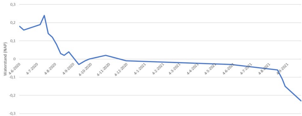
Figuur 4-3 Verloop waterpeil in compartiment 2 (Princen en Kalle, 2022).
