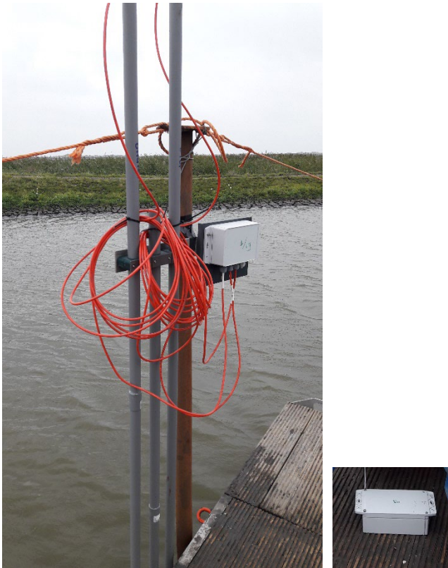
Figuur 3-5 Foto van een waterspanningsmeter gemonteerd aan de zakbaken op locatie 12 in de dunslibcompartimenten
