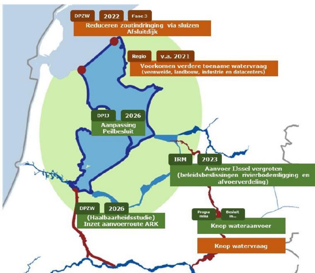
Figuur 3.8 Oplossingsrichtingen waarmee de watervraag kan worden gereduceerd (oranje) of het aanbod kan worden vergroot (groen) (Kielen & Mens, 2021)
