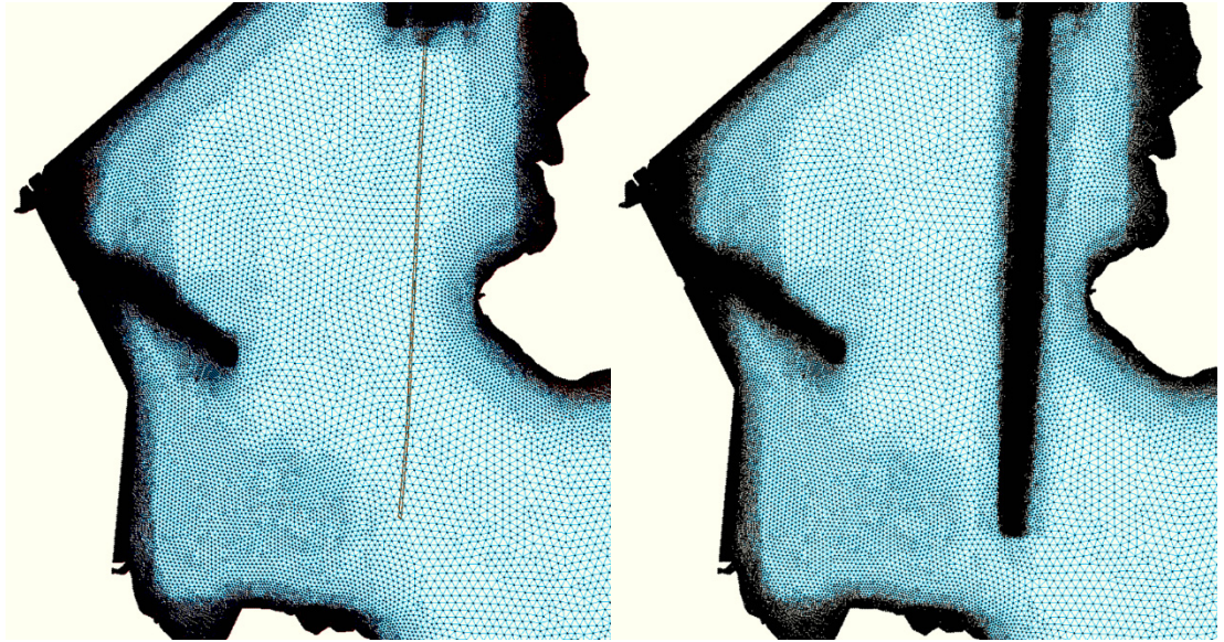
Figuur 2-2 Rekenrooster in het noordelijke deel van het IJsselmeer. Links het oorspronkelijke rooster uit 2020 met de contouren van de te verdiepen vaargeul en rechts het rooster van de huidige studie, verfijnd langs de vaargeul KWZ-UDO.
