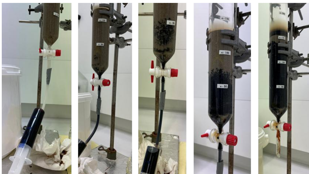
Figuur 14. Dosereren van teer aan een zandkolom
