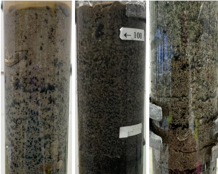
Figuur 17. Foto's van de gedraineerde kolommen met grof zand en kraanwater (links) grof zand en grondwater (midden) en fijn zand en grondwater (rechts)
