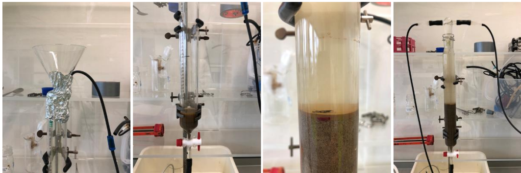
Figuur 10. Het vullen van een kolom met Griftpark zand en grondwater
