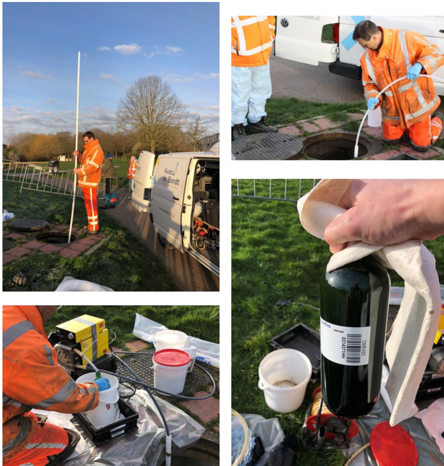
Figuur 5. Foto impressie van het oppompen van teer bij bron B22
