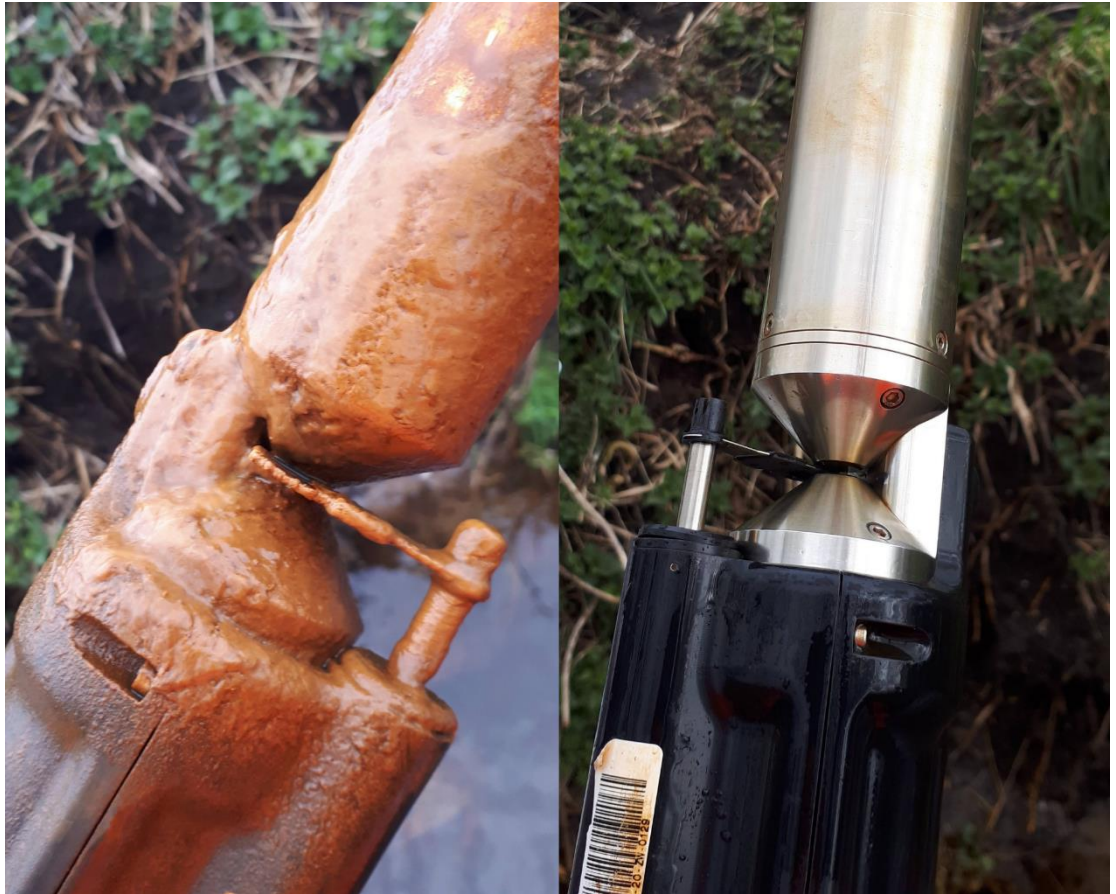
Figuur 3: Een UV-nitraatsensor met vervuiling in een ijzerrijke kwelsloot in een zandgebied. De wisser is niet krachtig genoeg om de aangroei weg te halen en veroorzaakte daarbij krassen op de lenzen (links). Rechts na schoonmaak van de sensor (foto's: Aquon).
