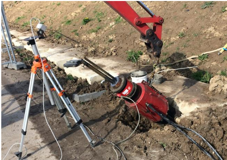
Figuur 3.6 Vijzel voor de controleproef en afspanning.
