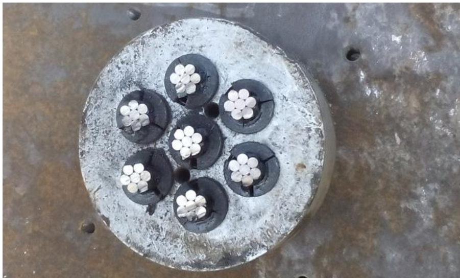
Figuur 3.7 Foto gesnelde strengen.
