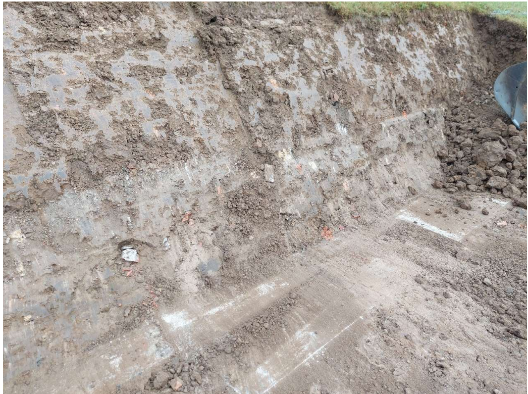
Figuur 1-18 Locatie N, overgang tussen toplaag klei en onderliggende laag te zien met aanwezigheid van puin.
