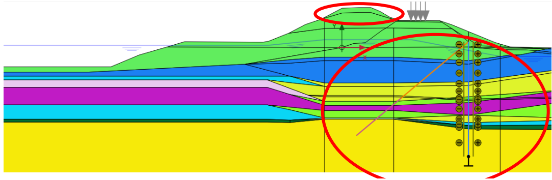
Figuur 4.5 Dijkversterking KIS, aanbrenge constructie (boorpalenwand aan) en daarna ophoging kruin.
