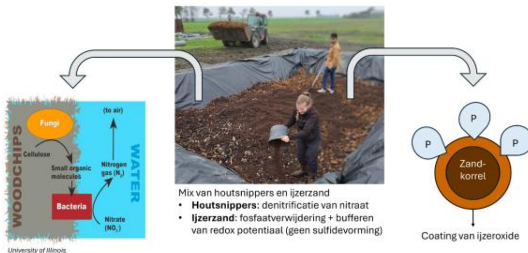
Figuur 4.1: Samenvatting van de twee gecombineerde principes van het houtsnipper-ijzerzandfilter op Hoeve Lotmeer: houtsnippers voor nitraatverwijdering en ijzerzand voor fosfaatverwijdering en buffering van de redoxpotentiaal.
