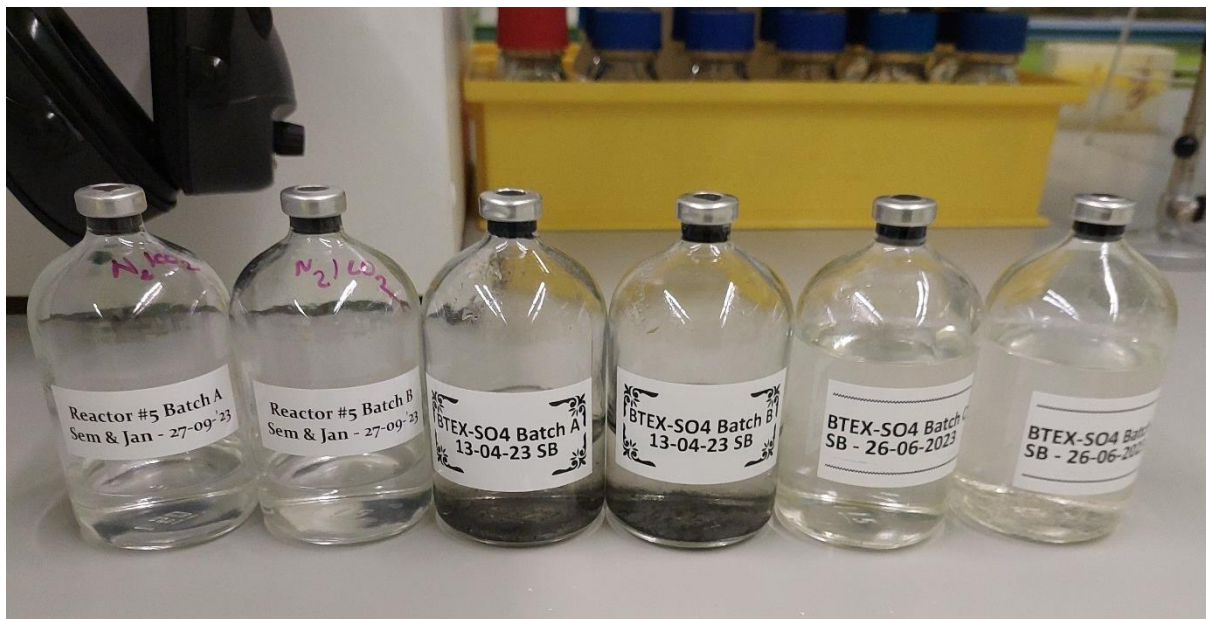
Figuur 2. Foto van de voorbereide batchincubaties. Reactor #5 batch A&B worden in de hoofdttekst batches E&F genoemd.
