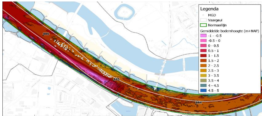
Figuur 3.1 Bodemhoogte en MGD-registraties te Nijmegen. (De Jong & Van der Mark, 2021)
