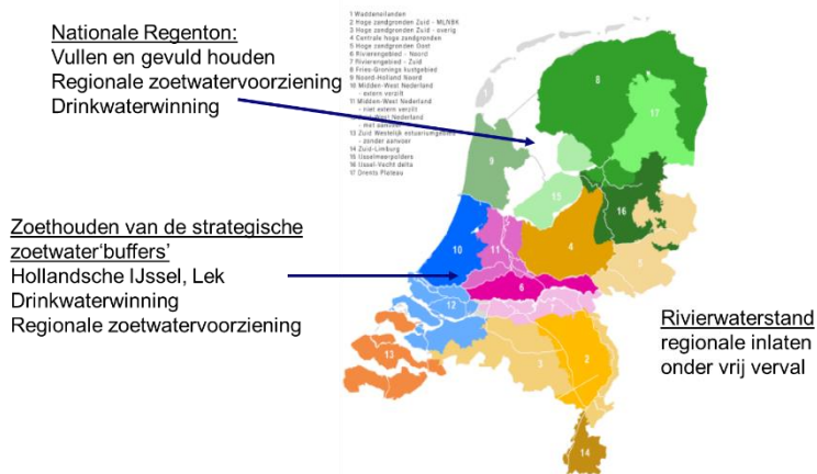
Figuur 4.1 Schematisch overzicht van de belangrijkste zoetwaterknelpunten als gevolg van afnemende rivierafvoeren
