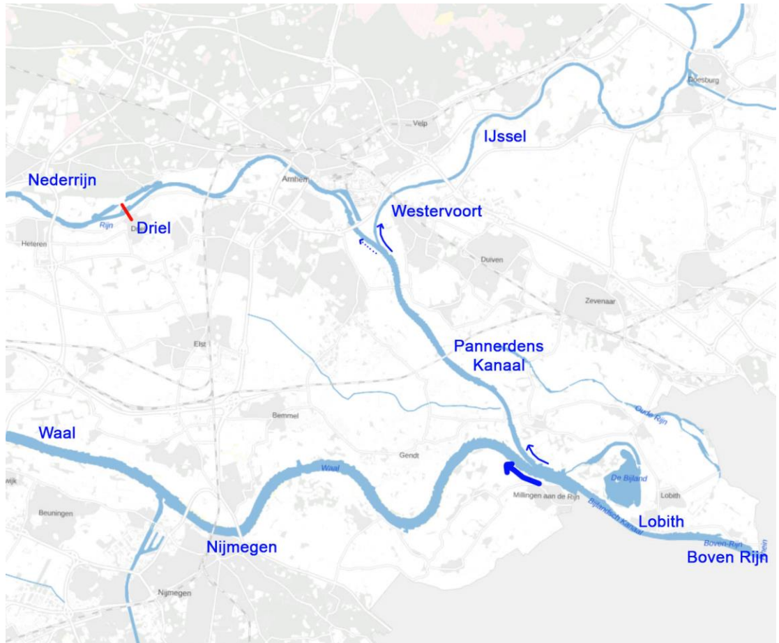
Figuur 2.9 Splitsingspunten van de Rijntakken. De Boven-Rijn splitst in de Waal en het Pannerdensch Kanaal bij de Pannerdense Kop. Het Pannerdensch Kanaal gaat over in de Neder-Rijn waarvan de IJssel afsplitst bij de IJsselkop. Stuw Driel is aangegeven met een rode lijn. Bron: https://www.waterpeilen.nl/berichten/zondag-9-september-2018-1548 .
