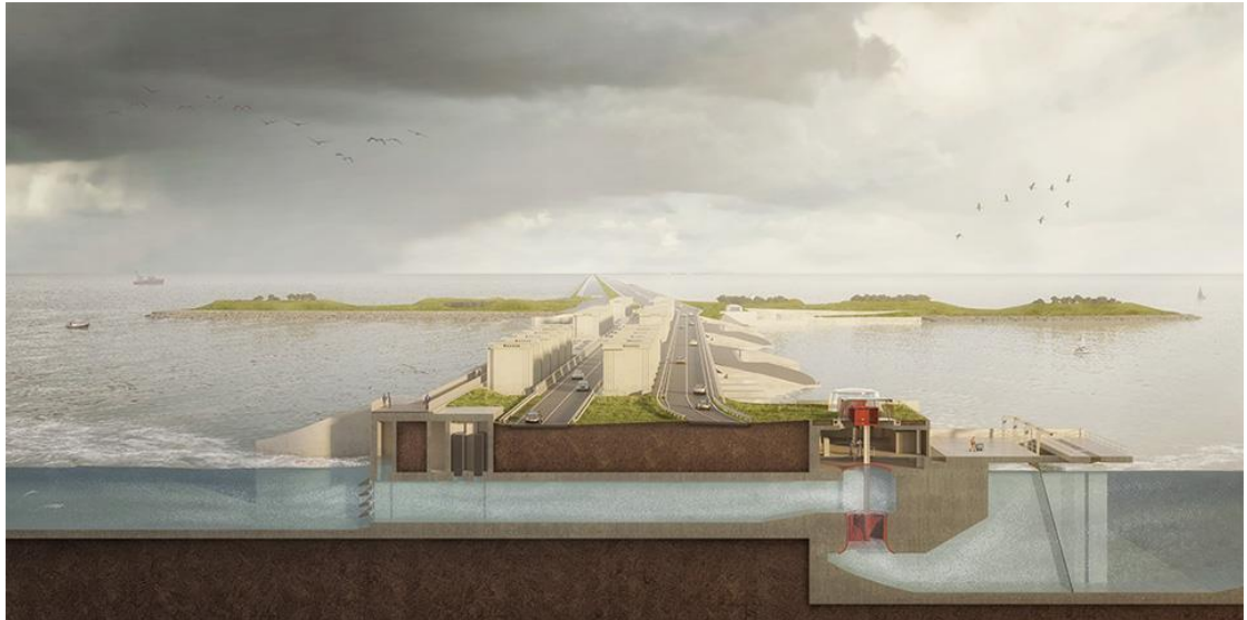
Figuur 8.56 Langsdoorsnede over het nieuwe gemaal bij Den Oever. Rechts: aanvoerkanaal, pomp met verticale as, links: terugslagkleppen met daarnaast 2 pompschuiven. Bron: https://iv-groep.nl/nl/blog/overzicht/nieuwe-pompgemalen-voor-de-afsluitdijk .
