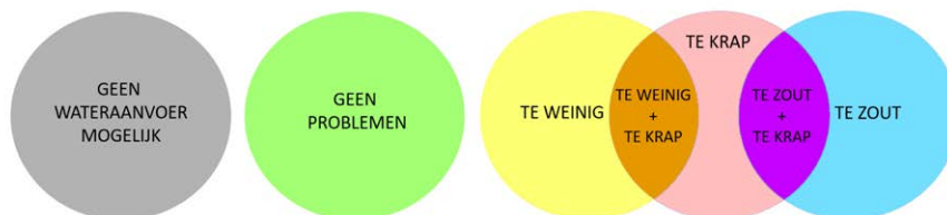
Figuur 23. Beeld van de oorzaken van watertekorten op basis van modelruns in de huidige situatie. In de grijze gebieden is geen water aan te voeren. Watertekorten ontstaan in de grijze gebieden door verdamping, neerslagtekort en als het grondwater niet voldoende wordt aangevuld waardoor het zout wordt. In de gele en roze gebieden is aanvoer beperkt mogelijk en ontstaan watertekorten doordat er minder water is om aan te voeren of omdat de aanvoercapaciteit te beperkt is. Op deze kaart zijn geen blauwe gebieden te zien. Dat komt omdat de er op dit moment nog geen doorspoeltekorten zijn om verzilting tegen te gaan. In de toekomst zijn wel blauwkleurende gebieden te verwachten.
