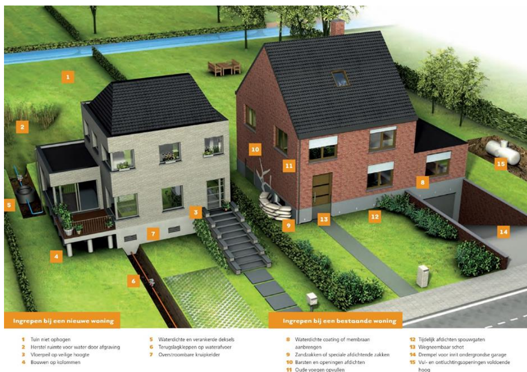
Figuur 2.3: Ingrepen bij een nieuwe of bestaande woning (bron: VMM, Commissie Integraal Waterbeleid, 2012)
