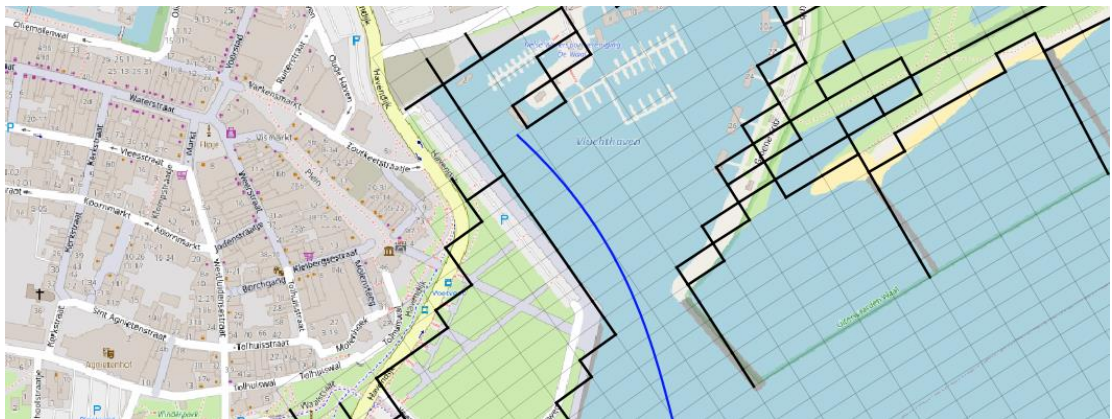
Figuur 4-16 Detail van het modelrooster in combinatie met de overlaten ter plaatse van de opening naar de vluchthaven. Het ADCP-transect is gemarkeerd met een blauwe lijn.
