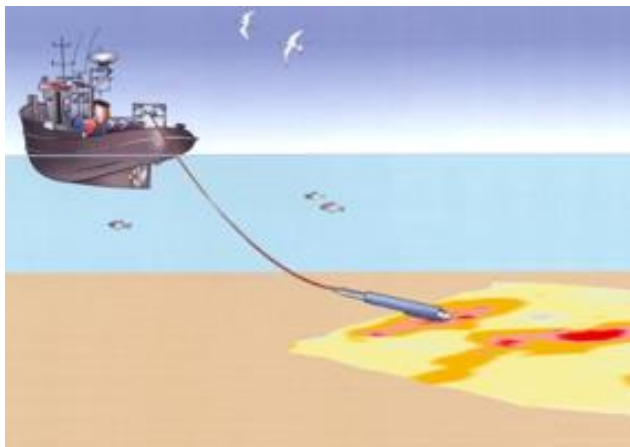
Figuur 16: De MS-1200 sensor sleept over de bodem en meet de natuurlijke radioactieve straling van het sediment (Medusa Institute)
