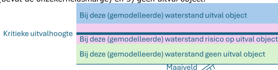
Figuur 4: Onzekerheid in uitvalhoogte. In blauw: de indicatie voor waterstanden waarbij het object uitvalt. In roze: de indicatie voor de onzekerheidsbandbreedte in de gemodelleerde waterstand, bij deze gemodelleerde waterstand kan het object mogelijk uitvallen. In groen: bij deze gemodelleerde waterstanden loopt het object geen risico op uitval.
