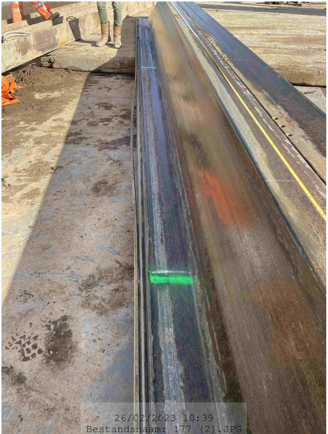
Figuur 3.2 Gescheurd slot plank 176 /177.
