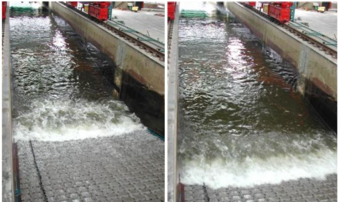
Figuur 3-11 Een lange golf gaat bruisend het talud op (Klein Breteler e.a., 2012)
