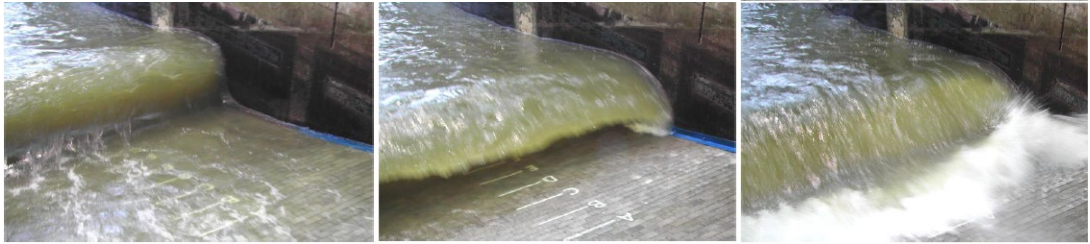
Figuur 3-10 Drie momenten in een overstortende golf (Klein Breteler e.a., 2012)
