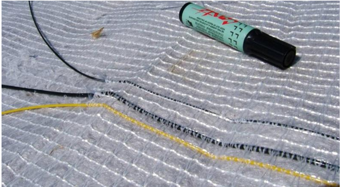
Figuur 4.4 Glasvezelkabels opgenomen in een textielmat (bron: Ten Cate).
