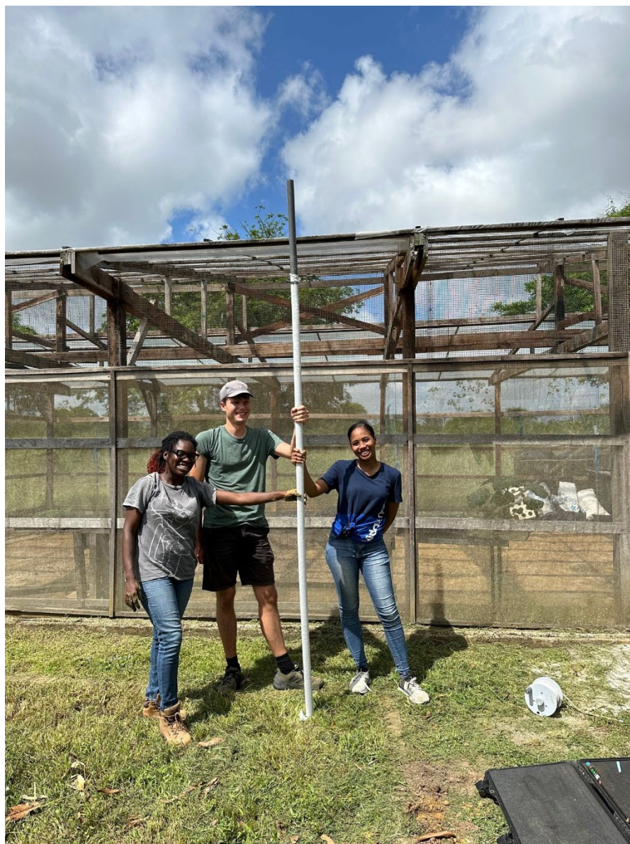
Peilbuis plaatsen (grondwatermetingen) op het terrein van de ADEKUS
