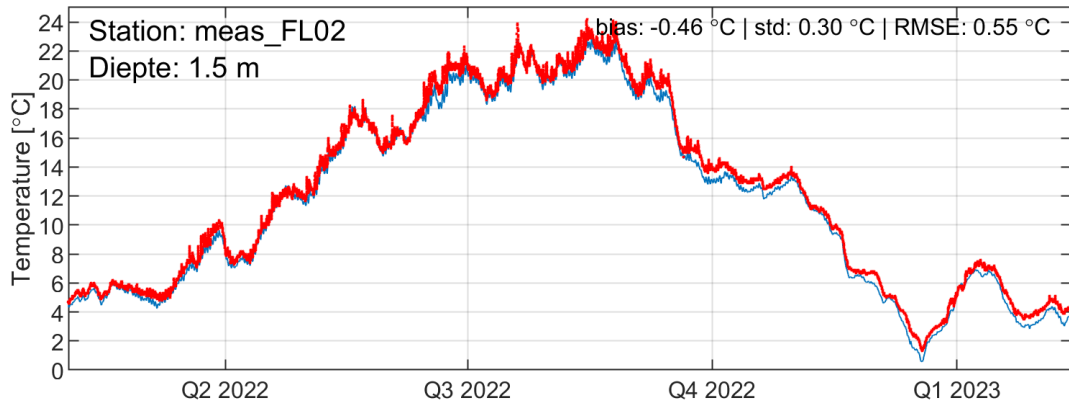
Figuur 5-49 Vergelijking gemeten en gemodelleerde watertemperatuur bij meetstation FL02.
