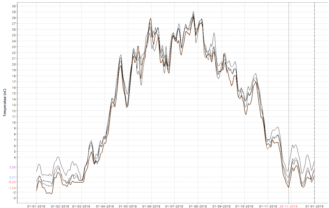
Figuur 2.17 Randvoorwaarden voor het LSM3: de geschatte temperatuur van de laterale afvoer is berekend met behulp van het 'bakjes'-model in Sobek2, en kan negatief zijn.
