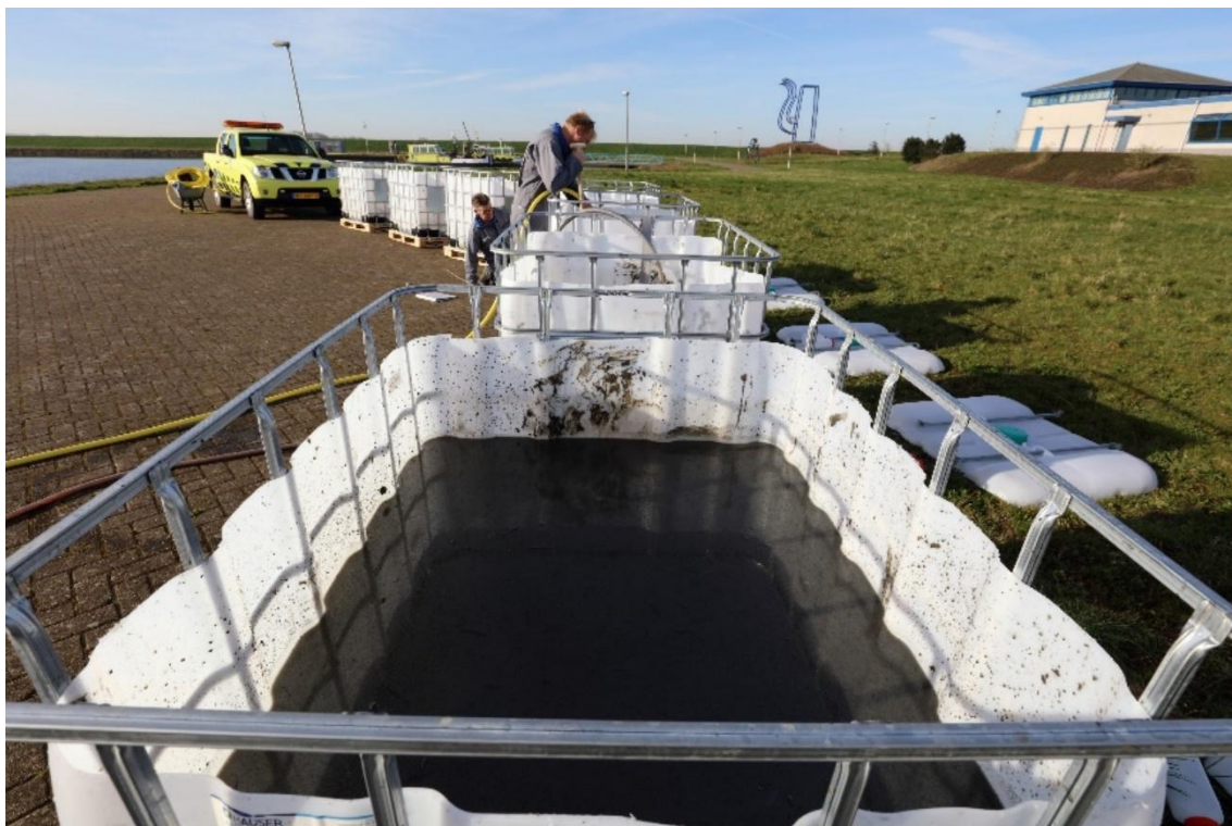
Figuur 2 Mesocosm experimenten voor 1½ jaar met verschillende type sediment, depot IJsseloog
