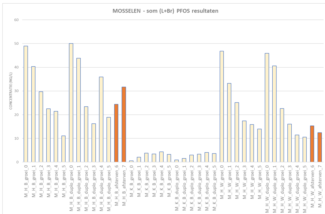
Figuur 27 PFOS concentraties in water in experiment met mosselen (M) proeven tijdens groei (duplo), Haringvliet en Kraanwater (H/K), met en zonder waterbodem (B/W)
