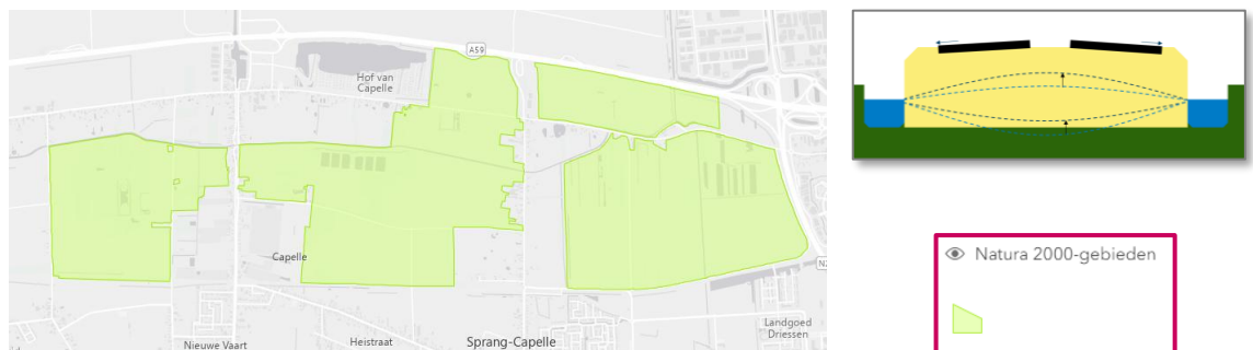
Figuur 2: Natura2000 gebied langs de A59, en hoe het slootpeil zich tot de grondwaterstand onder een weg verhoudt (schematisch). 12
